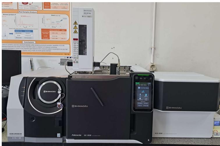
**Figura 15. Fotografía del prototipo 2 de GC-combustión-MS desarrollado junto a la empresa Shimadzu**
