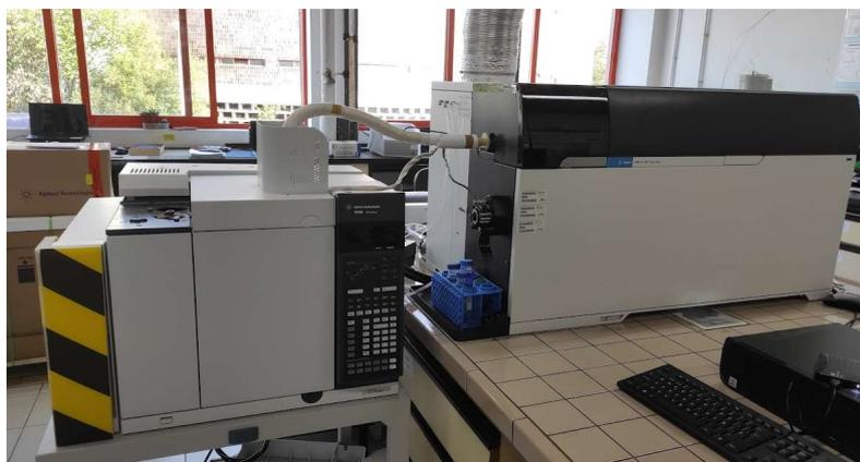
**Figura 12. Cromatógrafo de gases Agilent 7890B acoplado al detector selectivo de ICP-MS/MS Agilent 8900.**
