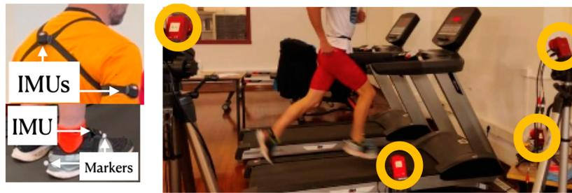
**Figura 5.2:** Izquierda: colocación de las IMUs y de los marcadores reflectantes para el sistema óptico MOCAP sobre el cuerpo del atleta. Derecha: disposición de las cámaras de Optitrack.
