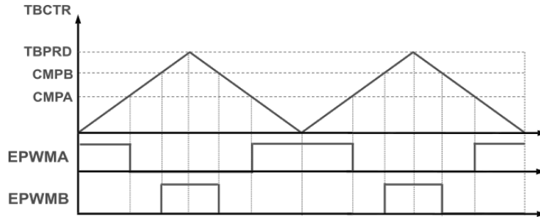
Figura 5.12: Contador TBCTR y los registros de comparación CMPB y CMPA, que producen las salidas EPWMA y EPWMB
