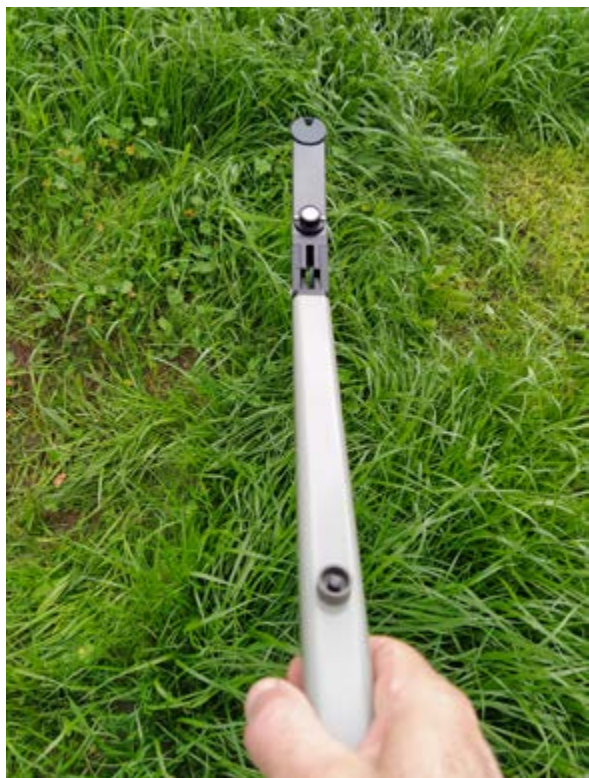
Medida do índice de área foliar cun analizador de cuberta vexetal (LI-COR® LAI 2000)
