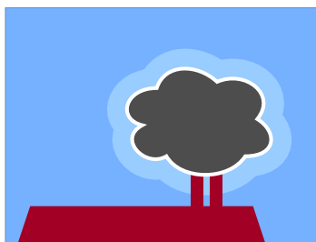
Figura 3.37: Obtención de las regiones de interés (Cielo, emisión, y edificio)
