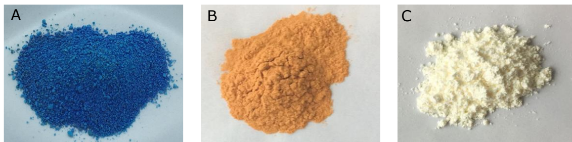
Figura 3.1. Fotografías de los tres materiales comerciales utilizados. Basolite C300 (A), Basolite F300 (B) y Basolite A100 (C).
