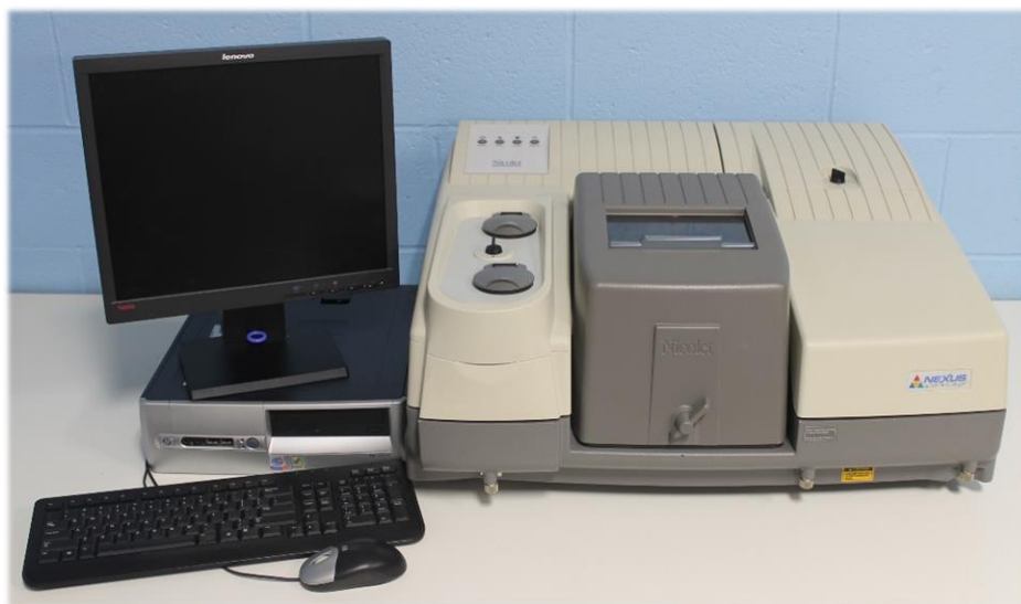
Figura 3.9. Equipo utilizado para la espectroscopía infrarroja de reflexión difusa por transformada de Fourier (DRIFT), Thermo Electron Nicolet FT-IR.
