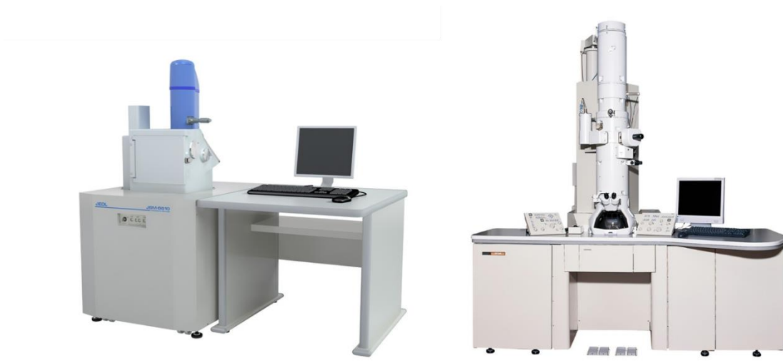
Figura 3.5. Equipos utilizados para la microscopía electrónica de los materiales estudiados. A la izquierda, JEOL-6610LV, a la derecha, JEOL JEM-2100.
