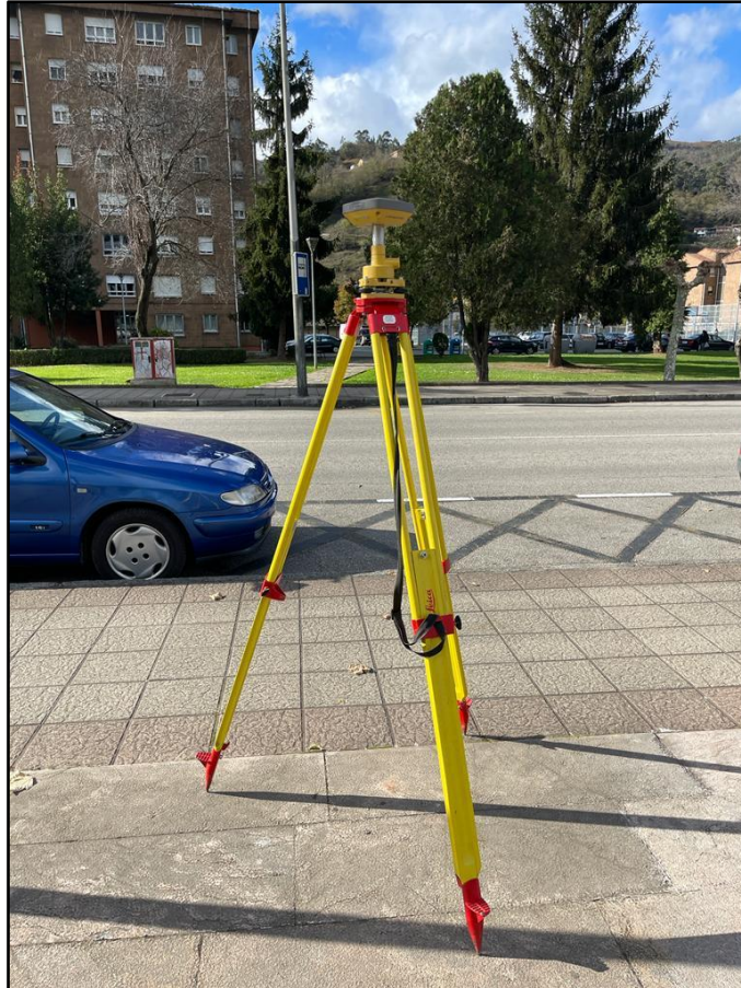
Figura 12. Fotografía de un levantamiento GNSS por el método estático-relativo en postproceso. En este caso el receptor está estacionado en un trípode. Fuente: Lydia Murias Cuervo.
