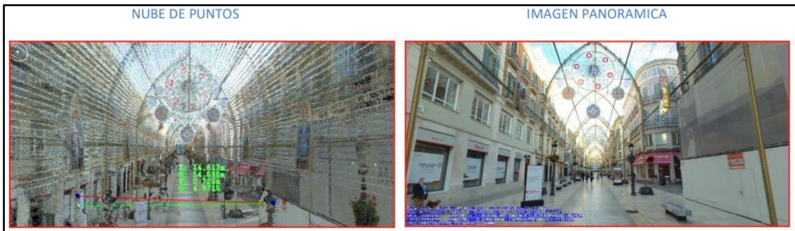
Figura 46. Ejemplo de nube de puntos coloreada, y de imagen panorámica generada a partir de los fotogramas de campo. Fuente: Documentación de Topcon sobre el procesado Mobile Mapping asociado al equipo IP-S3 con Magnet Collage [20].
