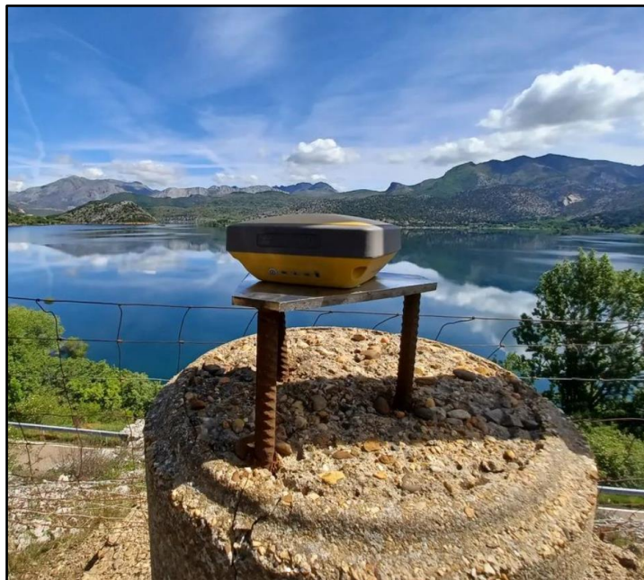
Figura 31. Receptor GNSS en pilar con centrado forzoso. Fuente: APGEO (Grupo EXCADE).
