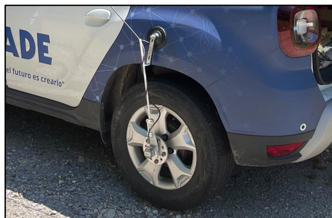
Figura 14. Odómetro instalado en el vehículo portador de un Mobile Mapping. Fuente: APGEO (Grupo EXCADE).
