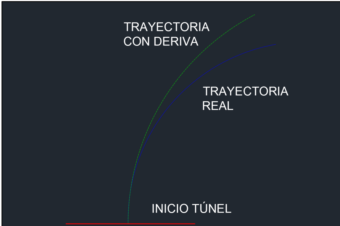
Figura 2. Esquema de la deriva que sufre la trayectoria. Fuente: Elaboración propia.
