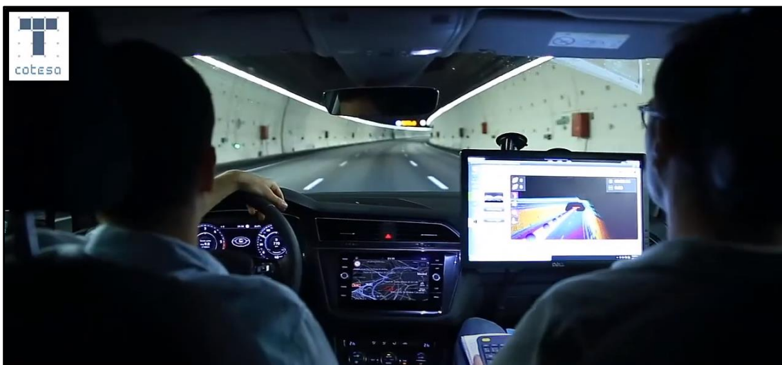
Figura 39. Fotografía de un proceso de captura Mobile Mapping en el interior de un túnel. Fuente: COTESA (Grupo TECOPY) [17].
