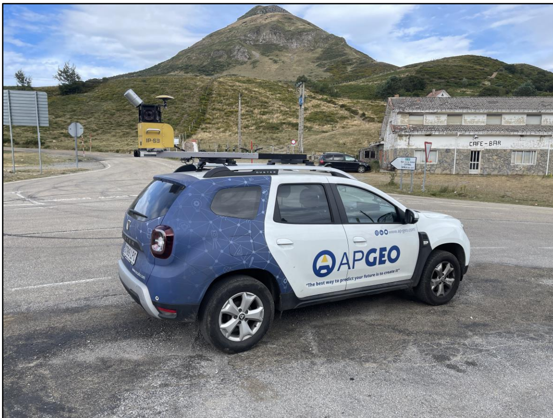
Figura 20. Topcon IP-S3 montado en vehículo APGEO. Fuente: APGEO (Grupo EXCADE).
