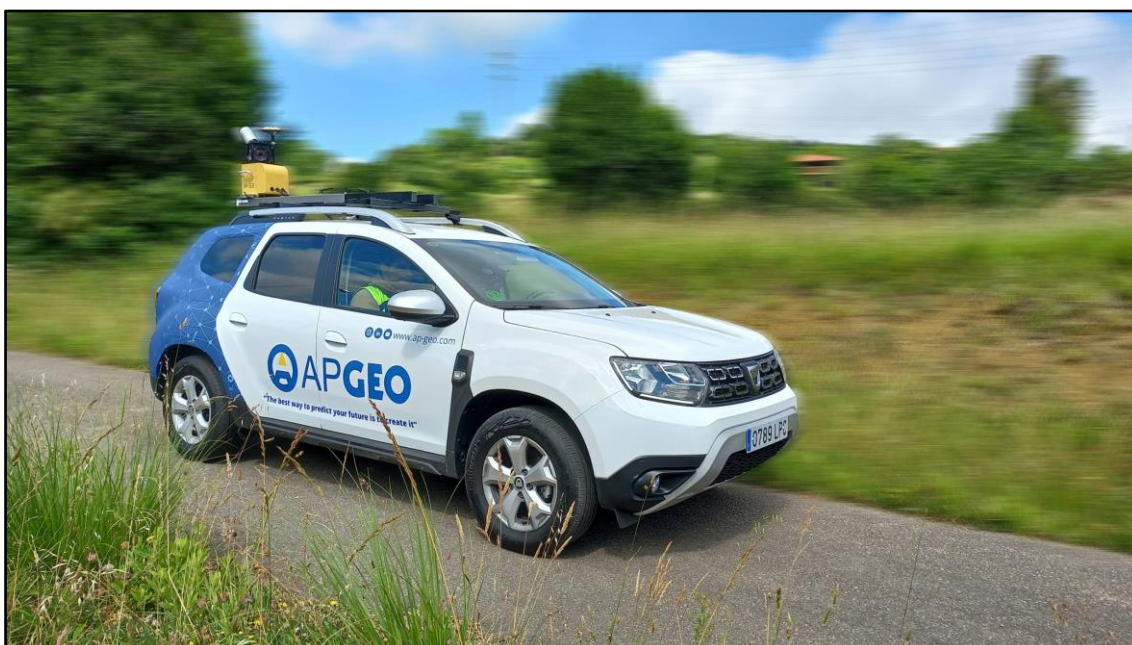
Figura 6. Sistema Mobile Mapping instalado en un coche. Fuente: APGEO (Grupo EXCADE).
