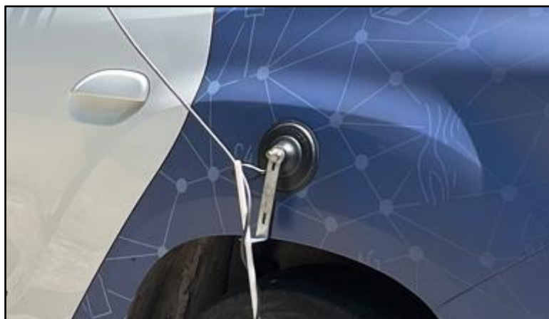
Figura 21. Imán de sujeción para la antena del odómetro. Fuente: Elaboración propia.
