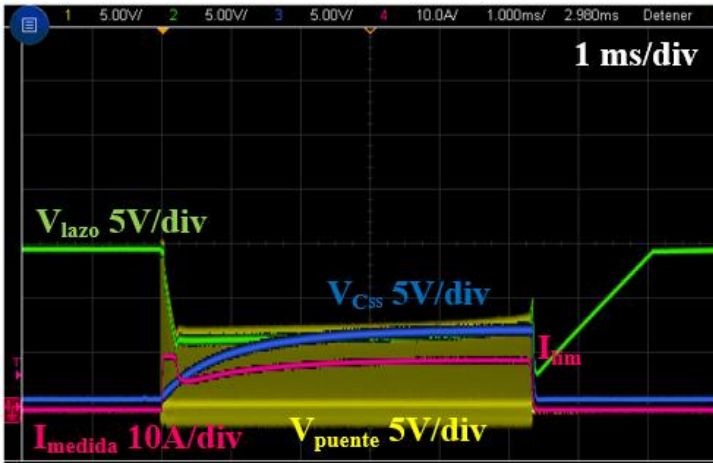
Fig.4.31. Activación del LCL directamente desde cortocircuito para una V_{bus} de 100 V, usando el circuito de arranque suave
