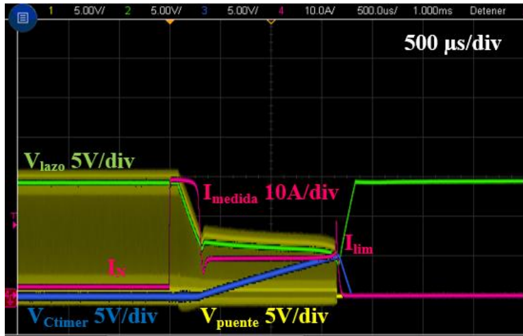
Fig.4.33. Funcionamiento del LCL, ante cortocircuito a su salida, usando un filtro LC entre el LCL y la carga, para una V_{bus} de 100 V y empleando el N-MOS de ST
