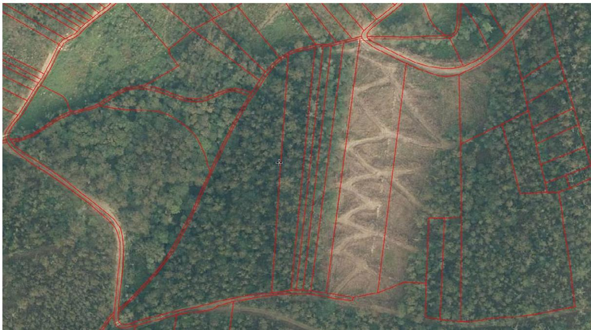
**Figura 5.3.** La combinación de parcelas pequeñas y alargadas en terrenos en pendiente dificulta mucho la apertura de pistas para poder mecanizar el procesado y apilado de la madera con cosechadora forestal desde pista, tras un apeo manual con motosierra (Fuente: SigPac).
