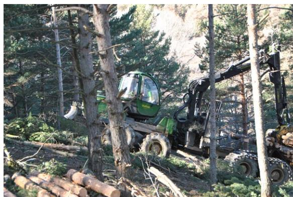
**Figura 5.4.** Procesadora John Deere 1270E trabajando en pendientes superiores al 30% y superando taludes de pista (superior) y autocargador John Deere 1910E en pendientes superiores al 30% (inferior) (Fotos: J. Pemán).
