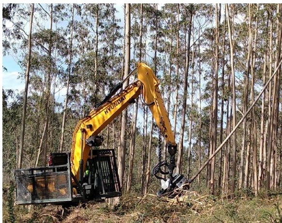
CPII.15. Apeo y procesamiento de eucaliptos empleando un cabezal cosechador montado sobre retroexcavadora de obra civil adaptada (Fotos: E. García Coya).
