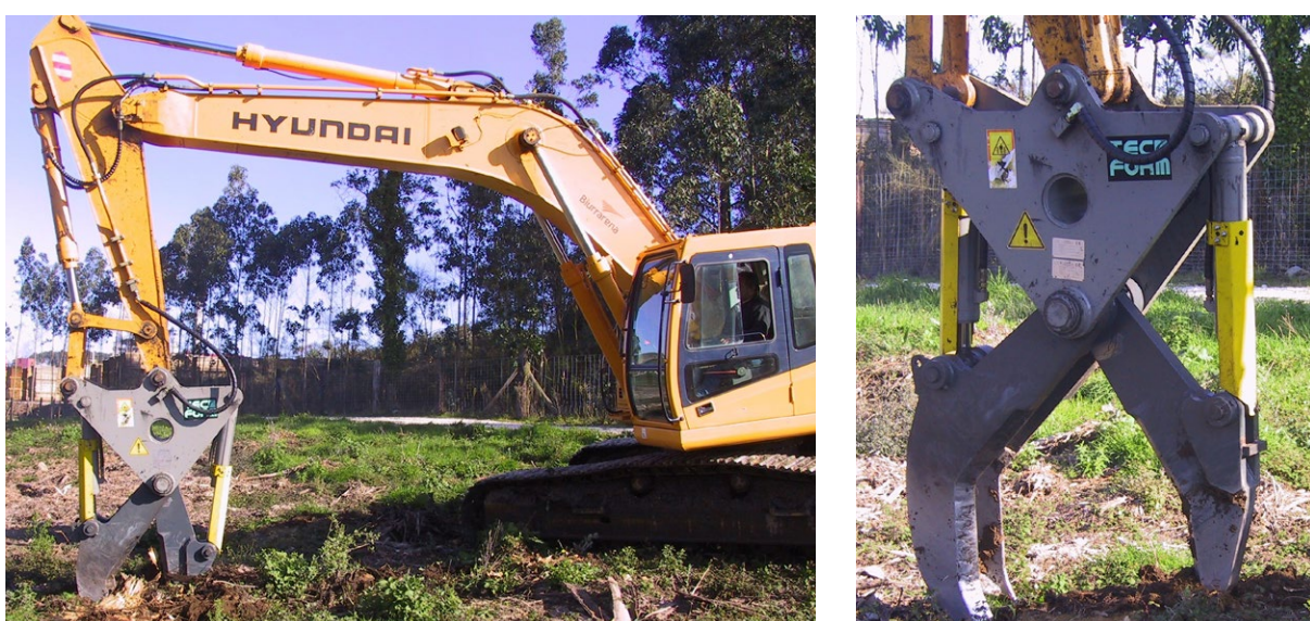
Figura CPII.23. Destocoado por destrucción in situ del tocón de eucalipto con la cizalla Tecform montada sobre retroexcavadora (izquierda). Detalle de las garras o dientes cortantes de la cizalla (derecha) (Fotos: M. Barrio Anta).
