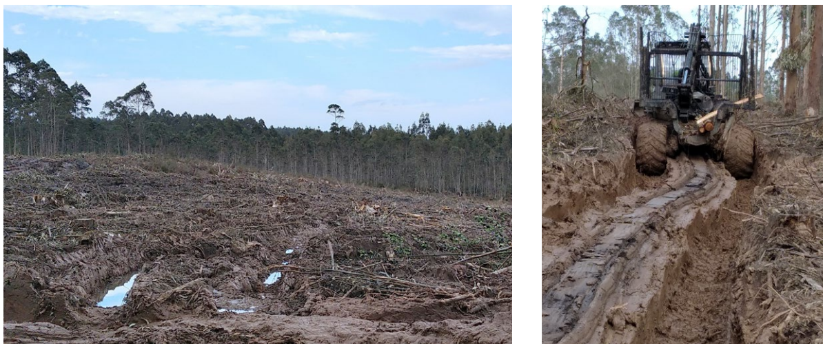
Figura CPII.4. Detalle del impacto ambiental de los aprovechamientos madereros en zonas con alta humedad en los suelos. Los autocargadores provocan grandes roderas y las ruedas tienen importantes problemas de adherencia (Fotos: E. García Coya).
