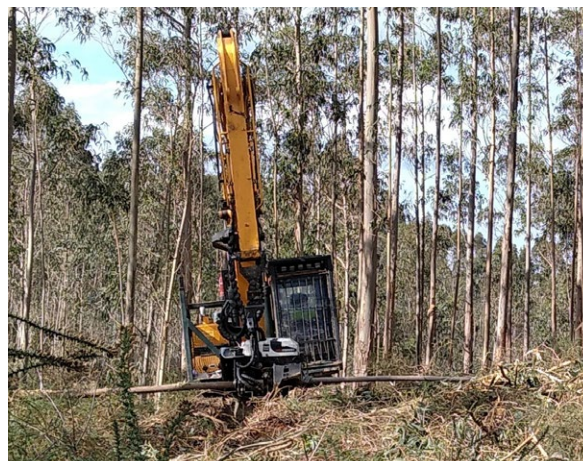
CPII.15. Apeo y procesamiento de eucaliptos empleando un cabezal cosechador montado sobre retroexcavadora de obra civil adaptada (Fotos: E. García Coya).
