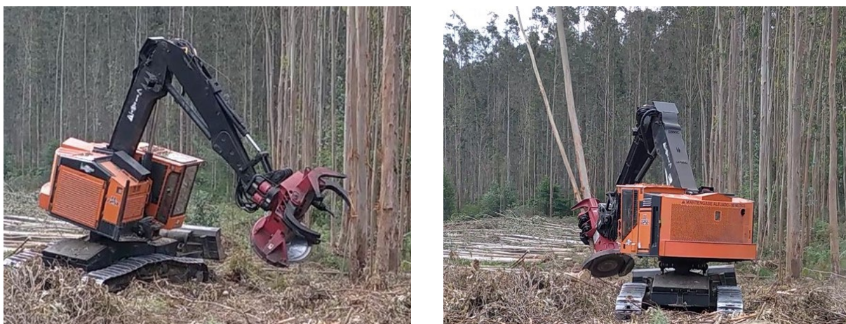
Figura CPII.17. Apeo de eucaliptos en el concejo de Colunga (Asturias) empleando una taladora-apiladora Timber Pro de cadenas con cabezal talador Quadco 22sc dotado de sierra de disco (Fotos: E. García Coya).
