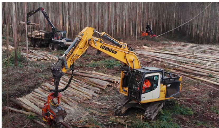
Figura CPII.16. Ejemplo de las tres máquinas usadas en este sistema: cosechadora forestal (en este caso cabezal procesador instalado en punta de grúa de retroexcavadora adaptada), taladora-apiladora (fondo dcho.) y autocargador (fondo izdo.) (Foto: Forestal Ría de Abres).
