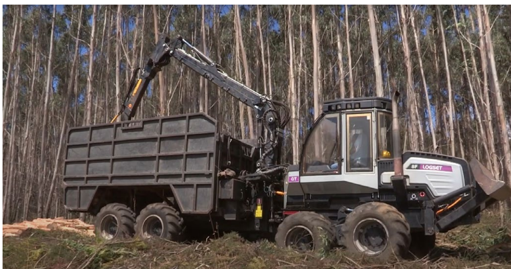
Figura CPII.11. Autocargador Logset con caja modificada y adaptada a carga transversal de trozas de eucalipto descortezadas (Foto: Maderas Paco Cacharolo).
