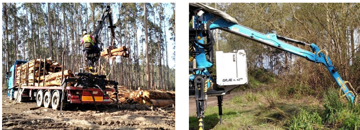
Figura CPII.21. Proceso de carga directa de un camión articulado utilizando la grúa propia instalada en la parte trasera del semiremolque (izquierda). Detalle de la grúa desacoplada dejada en el monte en espera de la siguiente operación de carga (derecha) (Fotos: E. García Coya).
