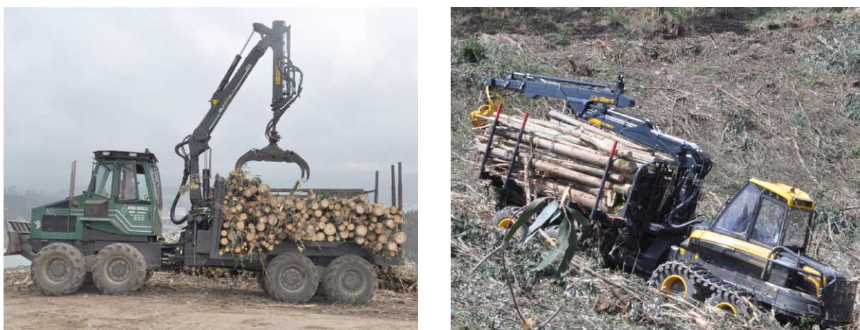
Figura CPII.9. Autocargadores de 8 ruedas motrices de alta capacidad. A la izquierda, desembosque de madera corta en carga transversal en modelo asturiano Dingo. A la derecha, desembosque de madera larga en carga longitudinal en modelo finlandés Ponsel (Fotos: M. Barrio Anta).
