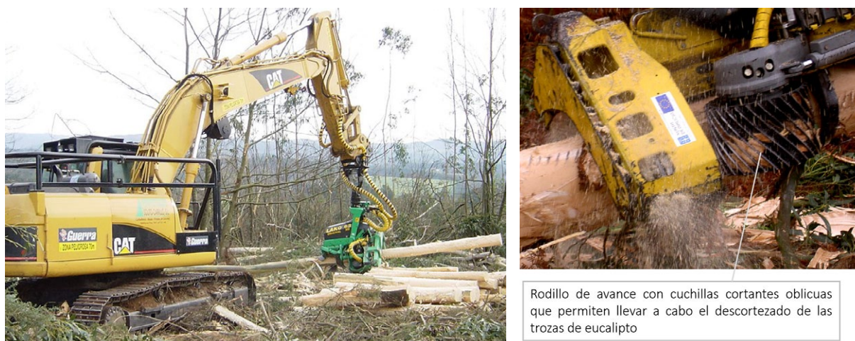
Figura CII.5. Descortezado simultáneo de trozas de eucalipto mediante el uso de cabezales cosechadores con rodillos dotados de cuchillas cortantes oblicuas que posibilitan el giro del fuste a la vez que avanza. Detalle de los rodillos de avance dotados de cuchillas cortantes inclinadas (derecha) (Fotos: F. Veiga Aguiar).
