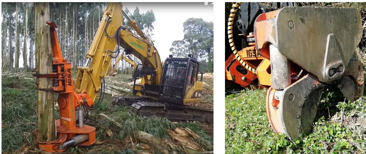
Figura CII.18. Apeo de eucaliptos con taladora-apiladora de cizalla TC.550 de IGSA montada sobre retroexcavadora adaptada (izquierda). Detalle de la cizalla de corte con cuchillas intercambiables (derecha) (Fotos: Industrias Guerra, izquierda y M. Barrio Anta, derecha).
