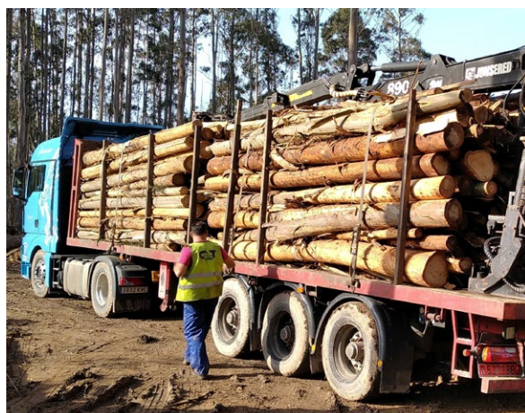
Figura CPII.20. Camión T2S3 cargado con dos estibas de madera de 5 m de longitud y grúa recogida en la parte trasera ya que se trataba del último transporte desde el monte (izquierda). Camión cargado con cuatro estibas de madera de 2,5 m de longitud (derecha) (Fotos: E. García Coya, izquierda y M. López Vázquez, derecha).
