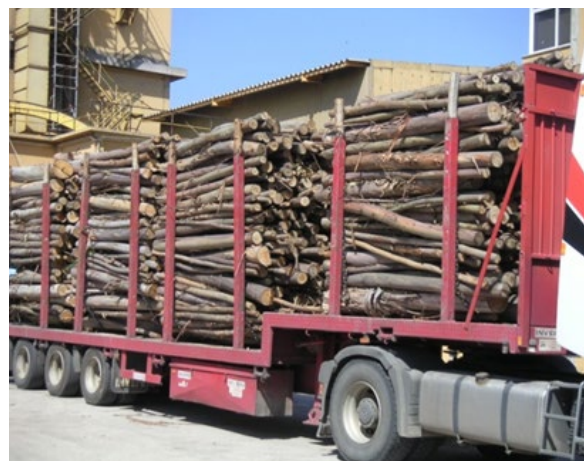
Figura CPII.20. Camión T2S3 cargado con dos estibas de madera de 5 m de longitud y grúa recogida en la parte trasera ya que se trataba del último transporte desde el monte (izquierda). Camión cargado con cuatro estibas de madera de 2,5 m de longitud (derecha) (Fotos: E. García Coya, izquierda y M. López Vázquez, derecha).
