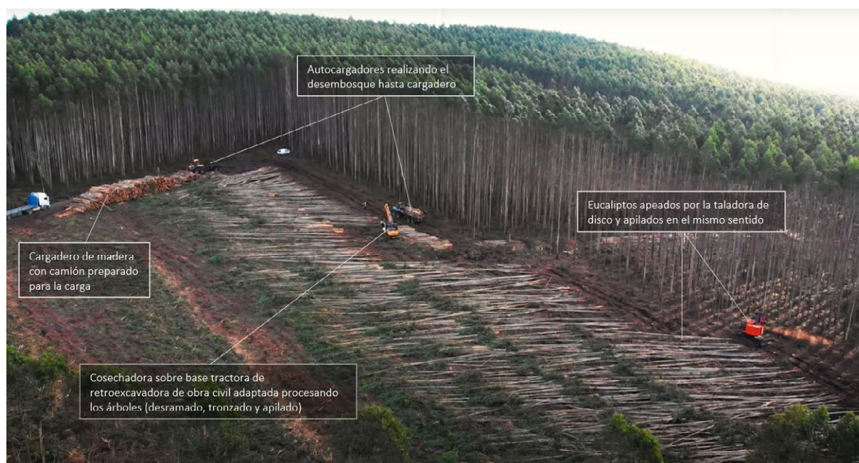
Figura CP11.19. Fotografía aérea de un aprovechamiento de eucalipto completamente mecanizado (Sistema Euca_03) utilizando una taladora-apiladora de disco, una cosechadora y dos autocargadores (Foto: Forestal Ría de Abres).
