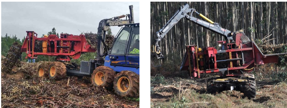
Figura CPII.22. Proceso de empacado de residuos de eucalipto con empacadora Enfo 2000 de la firma asturiana Monra (Fotos: Monra, izquierda y M. Barrio Anta, derecha).
