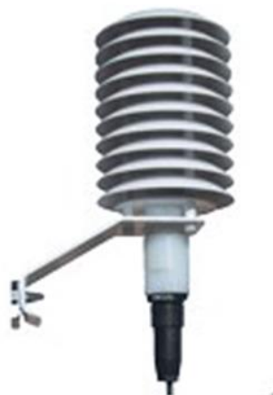
Ilustración 48. Sonda de temperatura con protección de radiación solar
