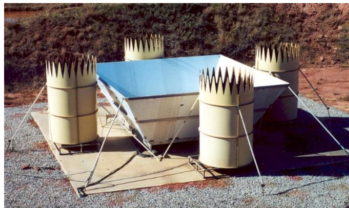
Ilustración 10. Ejemplo de un perfilador de viento [16]
