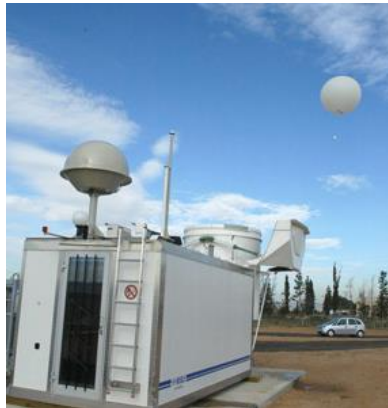
Ilustración 29. Lanzamiento de un radiosondeo desde un equipo automático [29]
