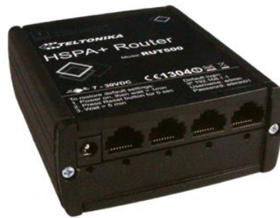
Ilustración 50. Modem 3G para la transmisión de estas
