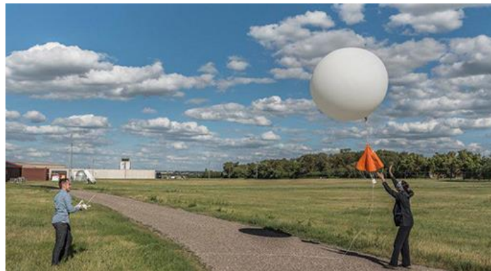
Ilustración 4. Globo meteorológico del NWS equipado con una radiosonda [12]
