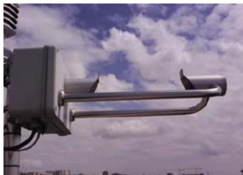
Ilustración 27. Detector de tipo precipitación [29]
