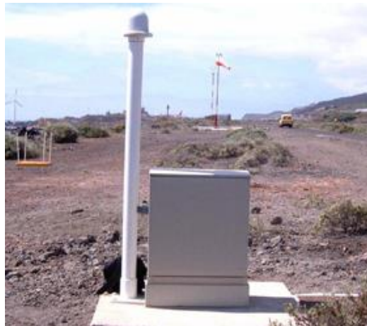
Ilustración 31. Equipo detector de descargas eléctricas [27]
