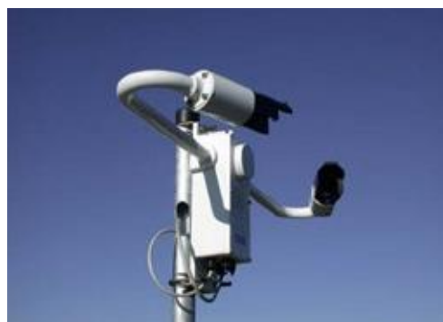
Ilustración 28. Medidor de visibilidad [29]
