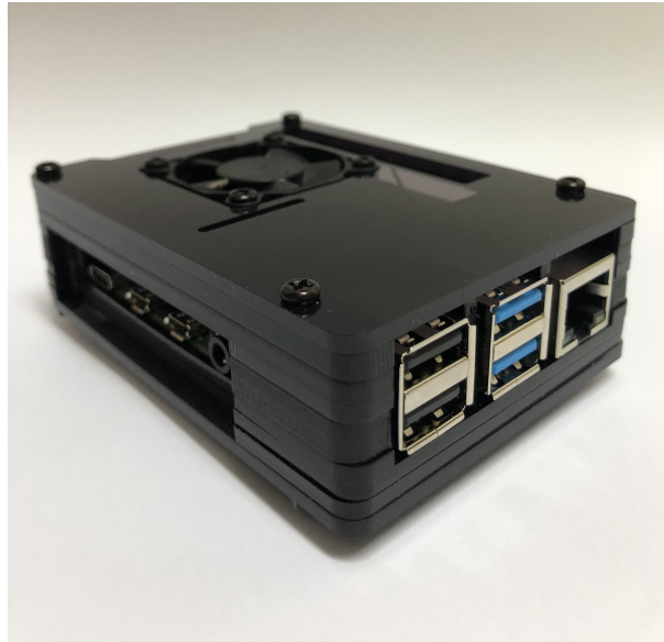
Figura 3.3.- Carcasa protectora con sistema de refrigeración
