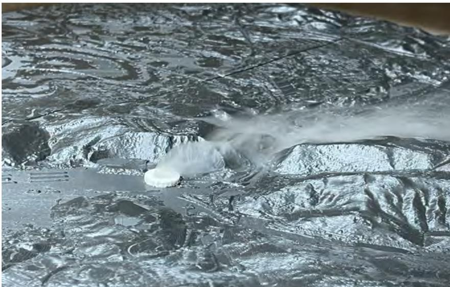
Figura 3.16: Detalle de las partículas saliendo del foco emisor sobre la orografía.
