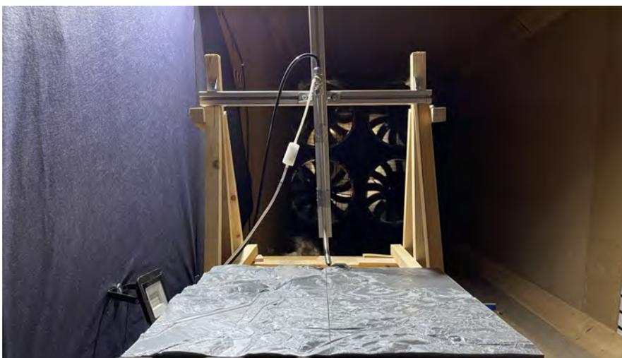
Figura 3.17: Vista frontal de la maqueta con el emisor de partículas encendido.
