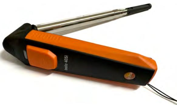
Figura 3.15: Anemómetro portátil empleado para medir la velocidad en el túnel de viento.
