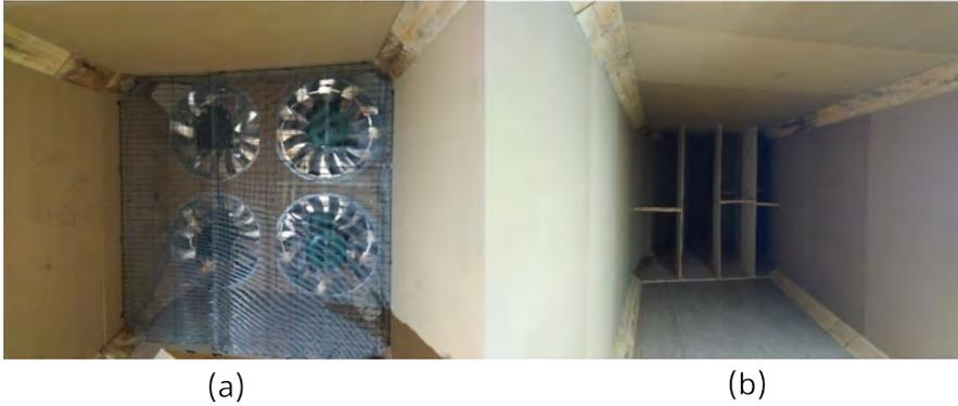
Figura 3.4: Vista de la cámara secundaria. (a) Aspiración de las ventiladores. (b) Deflectores.
