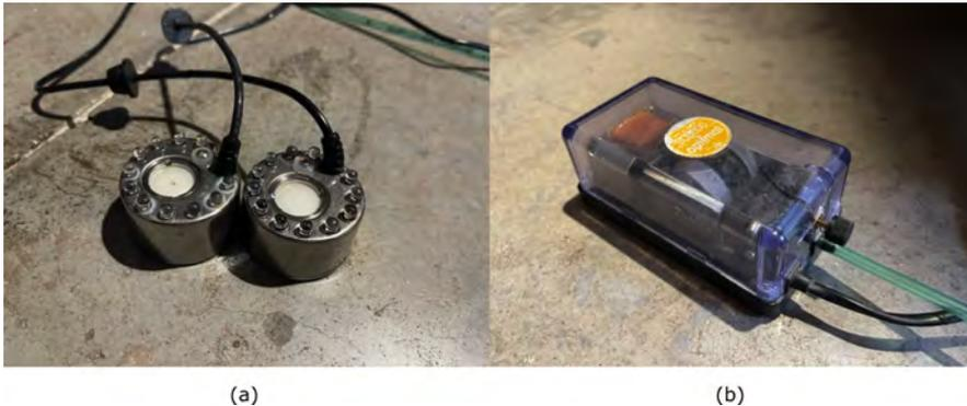
Figura 3.8: (a) Nebulizadores por ultrasonidos. (b) Compresor de aire.
