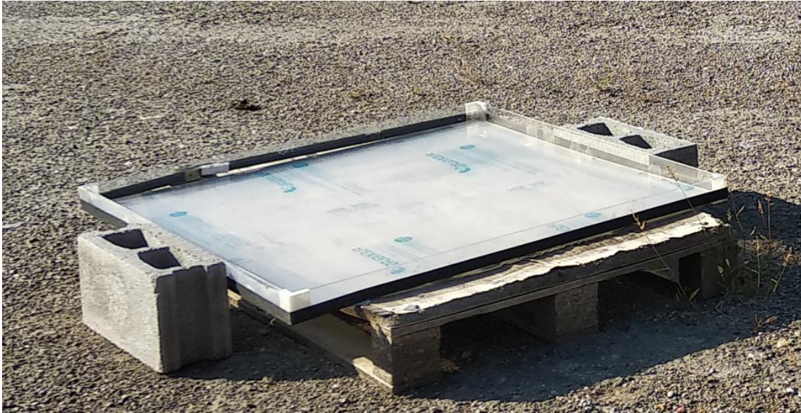
Figura 5.5. Captador de DSPM conformado por una bandeja cuadrada de metacrilato de 1 m 2 con paredes laterales de 0.05 m de altura, separables de la base, que evitan la pérdida de muestra una vez depositada.
