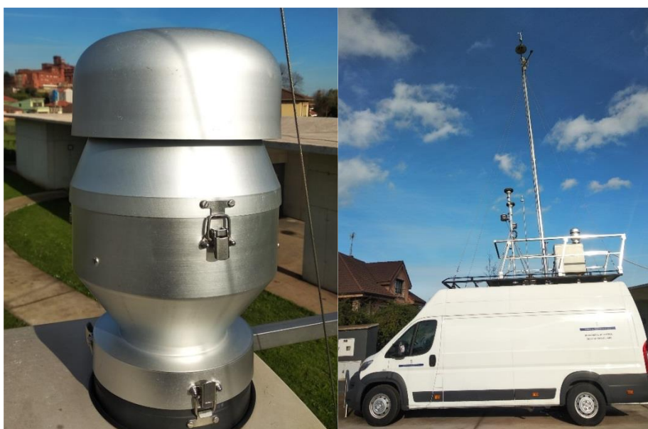
Figura 5.3. Captador de alto volumen secuencial MCV CAV-A/MSb instalado en la unidad móvil de control de calidad del aire y detalle del cabezal de corte PM10.
