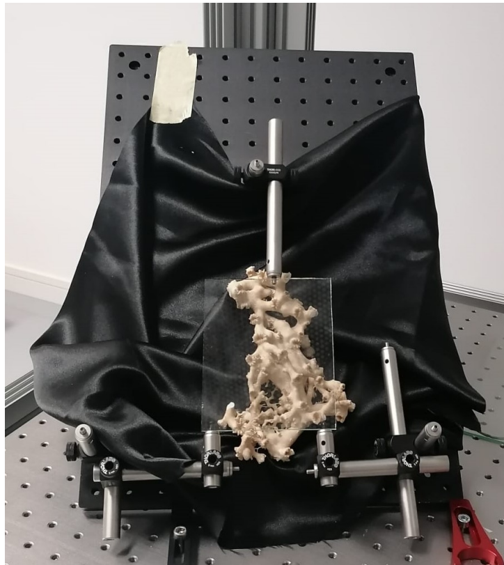
Figura 30: Coral del que se realizó el holograma con una placa revelada a modo de ejemplo colocada en la posición en la que se situarían las placas holográficas.
