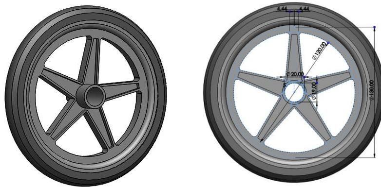
Figura 3.12. Diseño de las ruedas delanteras
