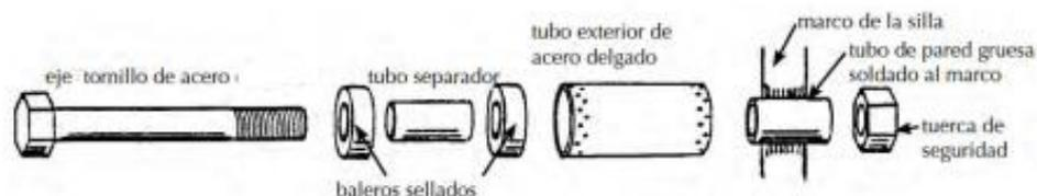
Figura 4.7. Montaje y despiece del eje de las ruedas
