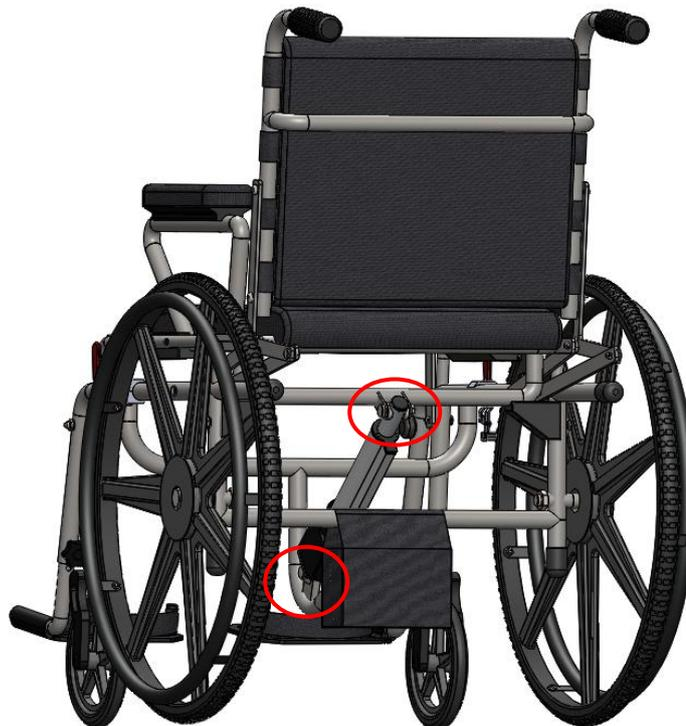
Figura 3.13. Indicación de puntos de anclaje del cilindro actuador
