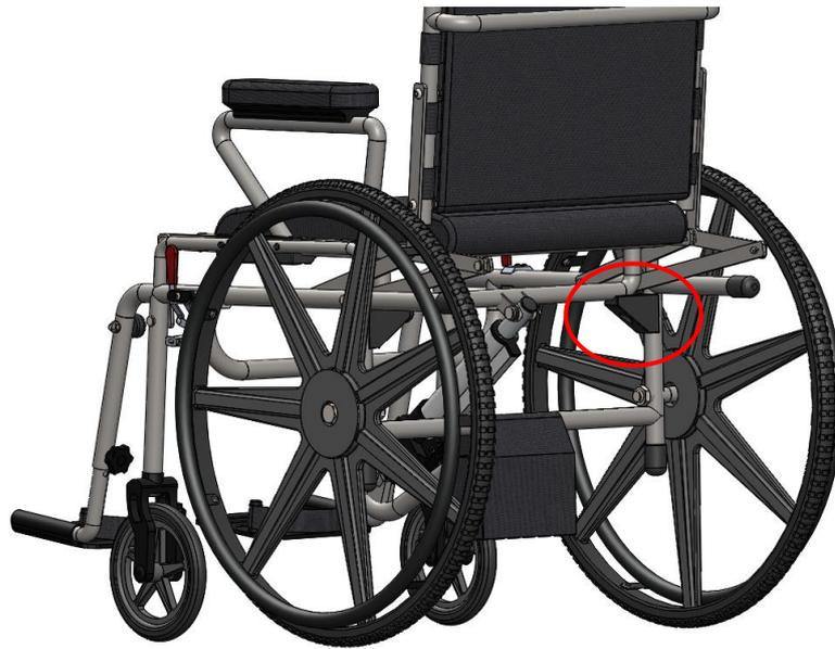
Figura 3.33. Posición de los topes de reposo en la silla de ruedas
