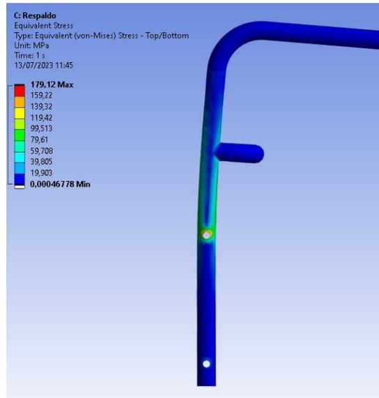
Figura 4.6. Análisis por elementos finitos del respaldo
