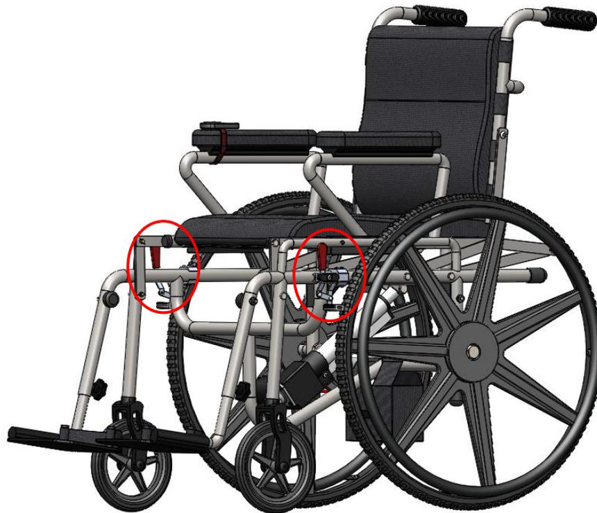
Figura 3.24. Posición de los frenos en la silla de ruedas
