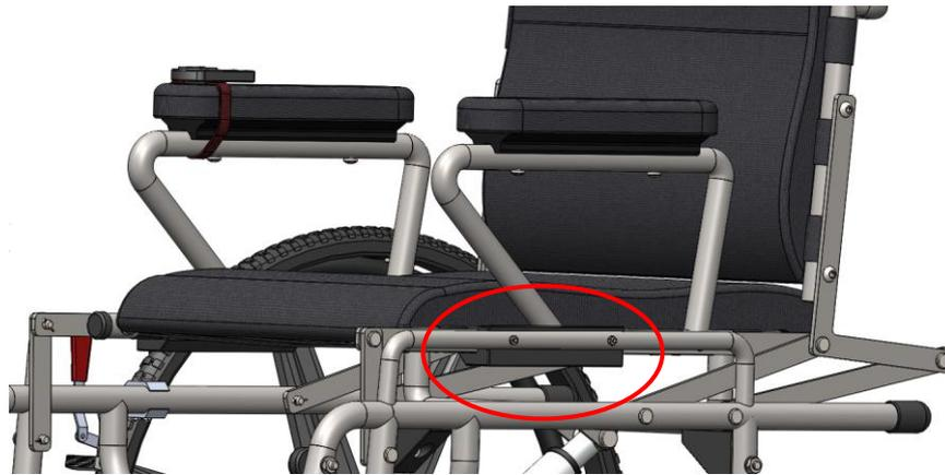
Figura 3.31. Posición del tope guía en la silla de ruedas
