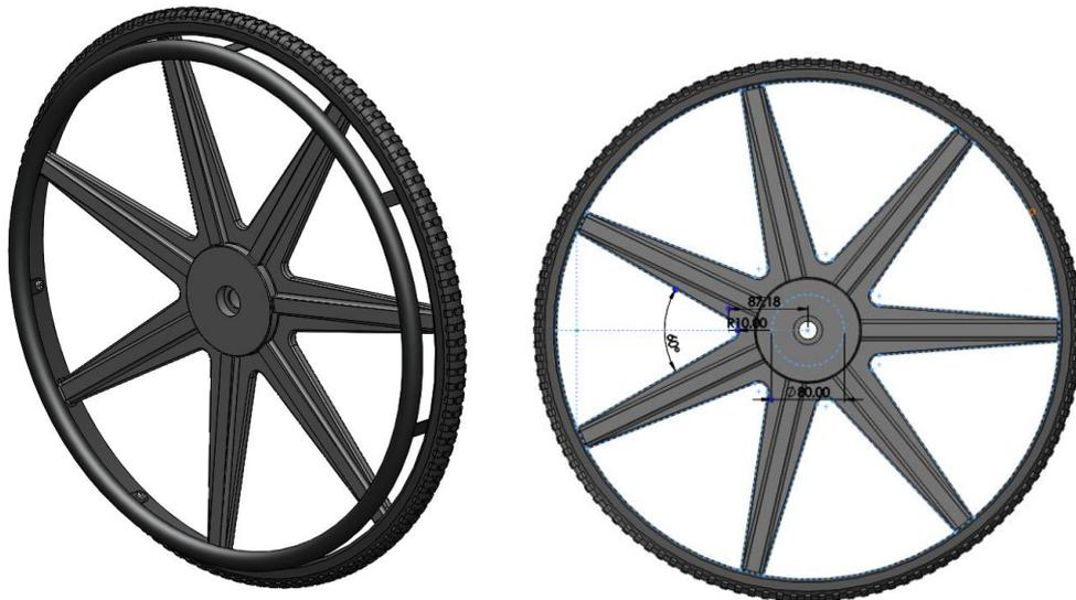
Figura 3.11. Diseño de las ruedas traseras
