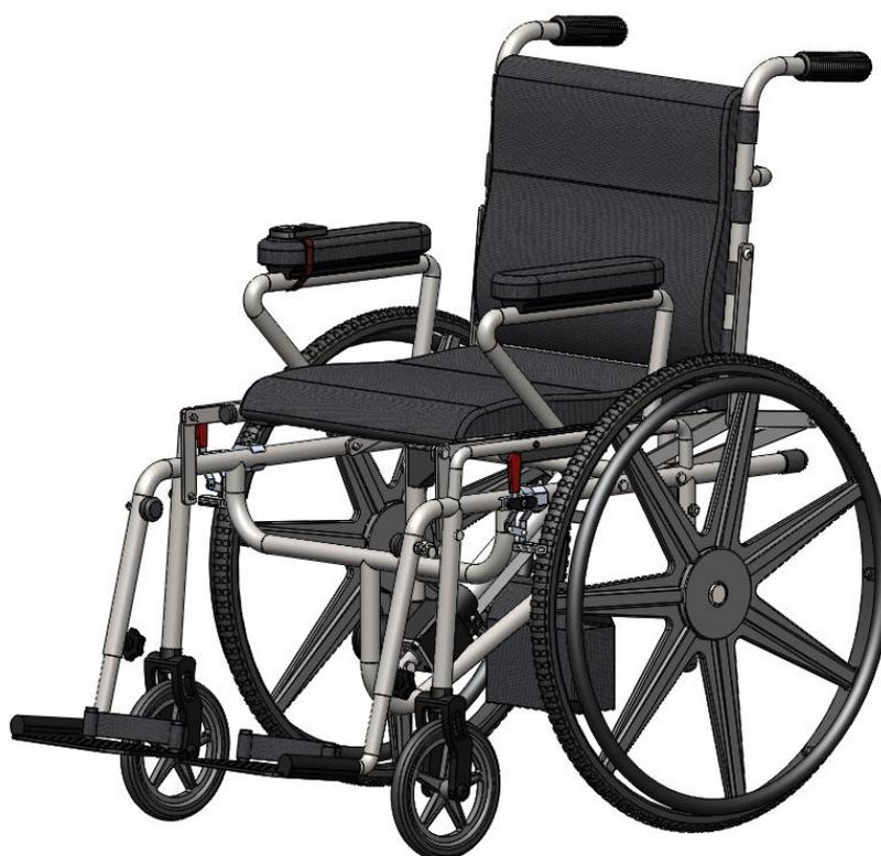
Figura 3.6. Diseño completo de la silla de ruedas
