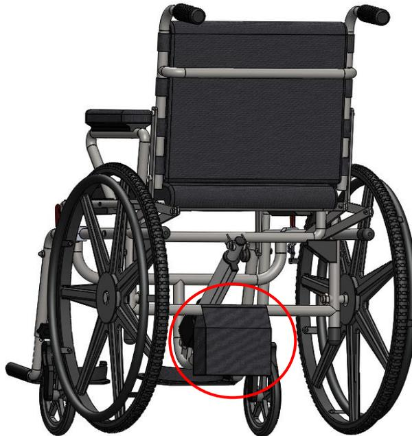
Figura 3.20. Posición de la carcasa de la batería
