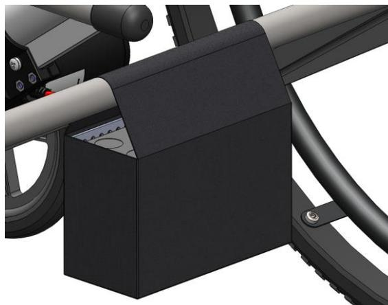
Figura 3.21. Detalle de la batería junto con la carcasa y la funda
