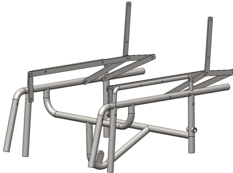
Figura 3.5. Diseño del mecanismo bipedestador
