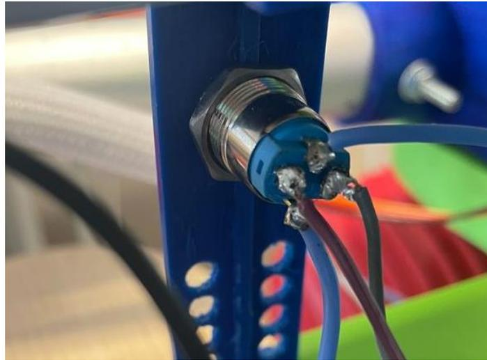
*Ilustración 75. Soldadura final de cables para la conexión del pulsador.*
