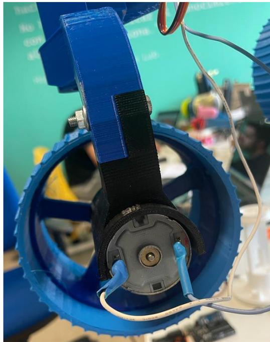
Ilustración 47. Vista del motor con sus dos cables y sus protecciones.
