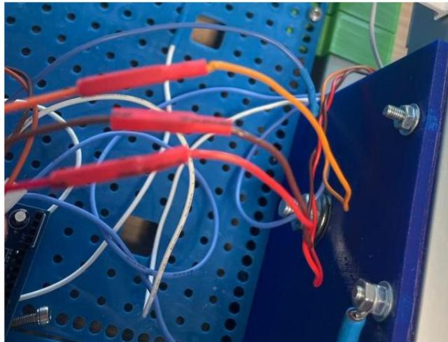
*Ilustración 54. Vista de la protección del alargamiento de cables de los servomotores.*
