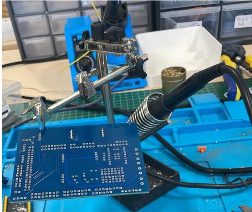
Ilustración 89. Preparación de estación de soldadura.
