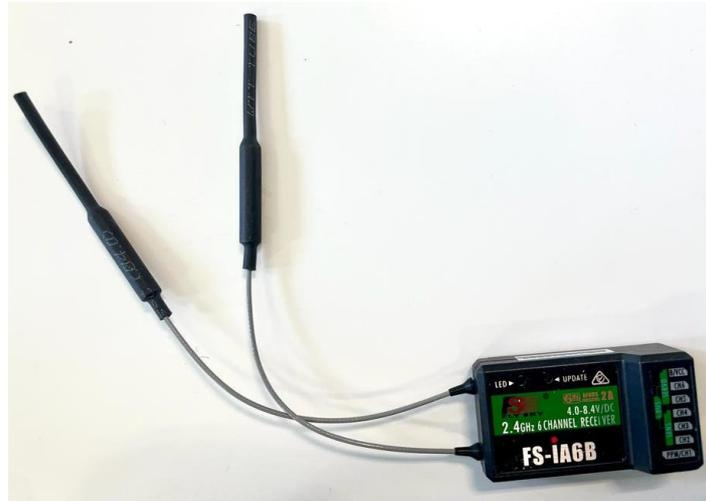
*Ilustración 68. Receptor RC comercial utilizado.*
