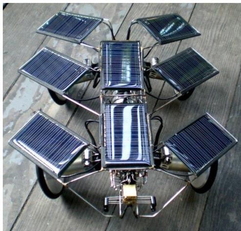
Ilustración 31. Robot alimentado por paneles solares [37].
