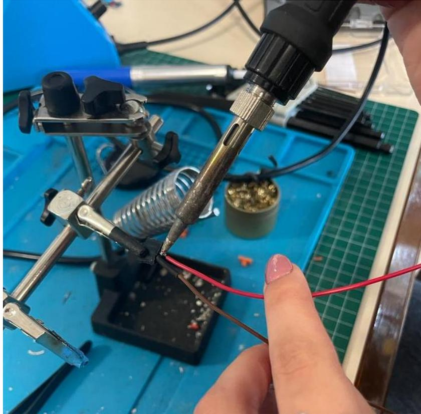
*Ilustración 56. Proceso de soldadura de los conectores de PCB como terminales de los servomotores.*
