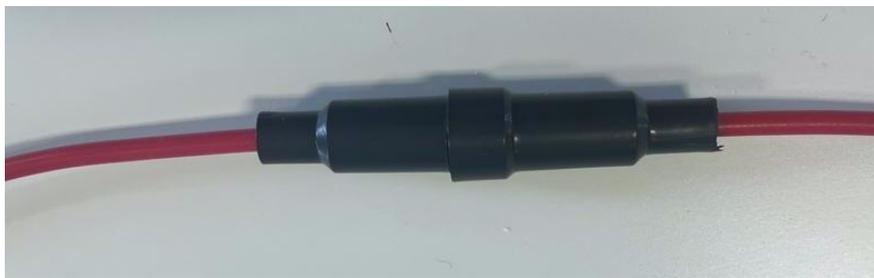
*Ilustración 64. Vista final de la protección cerrada del fusible.*
