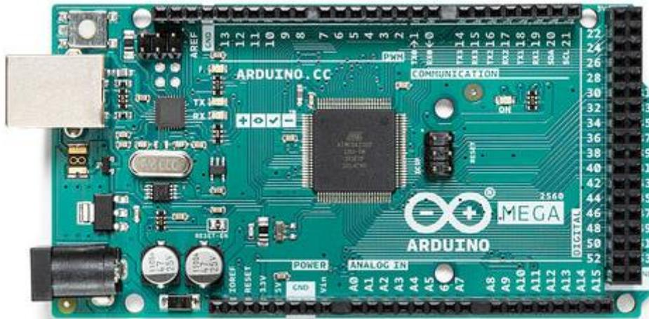
*Ilustración 35. Arduino Mega 2560.*
