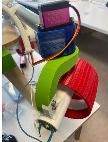
*Ilustración 58. Vista del servomotor colocado.*
