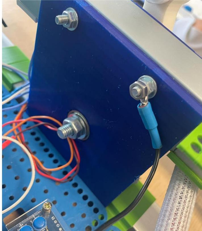
*Ilustración 81. Tierra de protección insertada en la estructura.*
