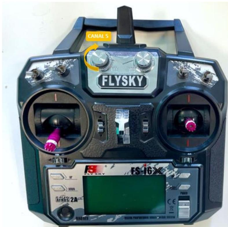
*Ilustración 108. Canal 5 del mando de control.*
