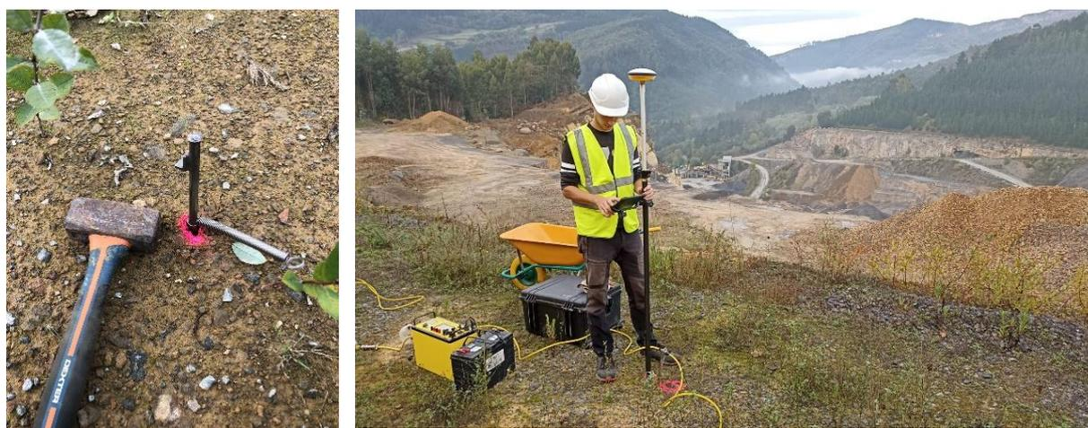
**Figura 12.** Izda.: Piqueta clavada en el lugar marcado previamente con pintura. Dcha.: Toma de datos de la ubicación de cada electrodo con el sistema GNSS RTK E200.
