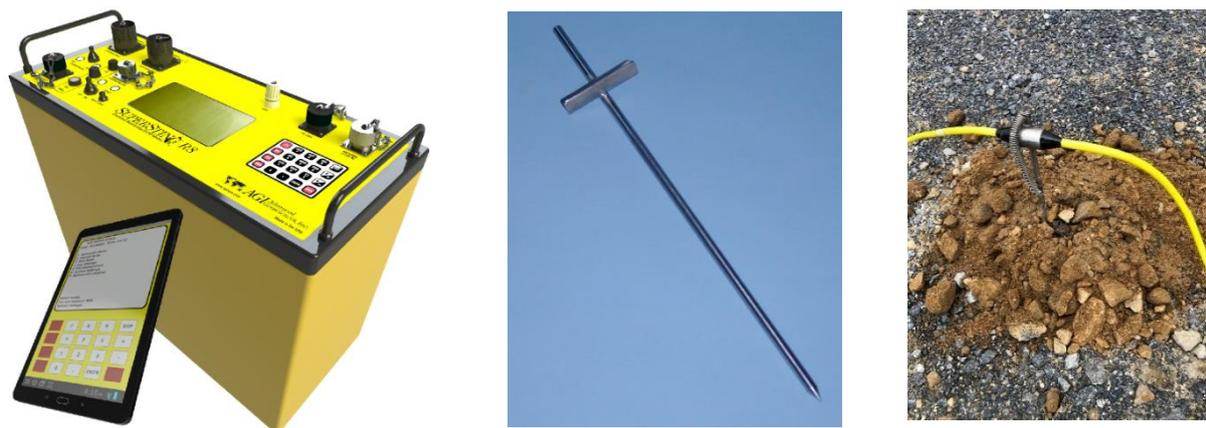
**Figura 13.** Foto del equipo, de izquierda a derecha: resistivímetro, piqueta y electrodo en el cable.
