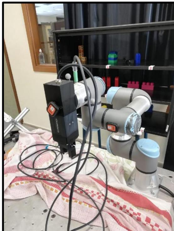
Figura 17.2.- Vista isométrica del montaje experimental elaborado en el robot colaborativo *UR3e*, disponible en el *RoboLab* de la *EPI Gijón*.
