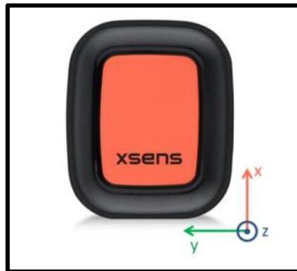
Figura 17.1.- Sistema de coordenadas vinculado a las unidades de medida inercial de la gama *Xsens DOT*. Imagen extraída como cortesía de [36].
