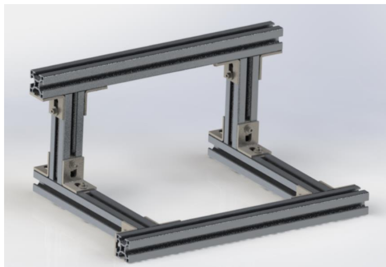
Ilustración 3.10 - Bancada del prototipo acoplamiento Schmidt.
