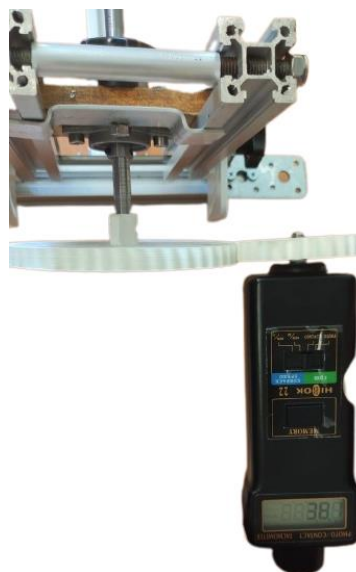
Ilustración 4.35 - Toma de velocidad del eje de salida con tacómetro.
