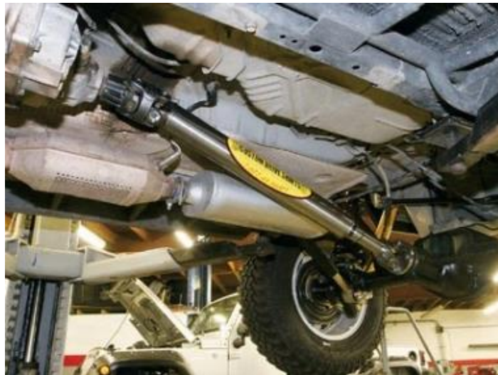
Ilustración 4.5 - Doble junta cardan utilizada en un vehículo.
