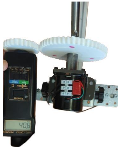
Ilustración 4.34 - Toma de velocidad del eje de entrada con tacómetro.
