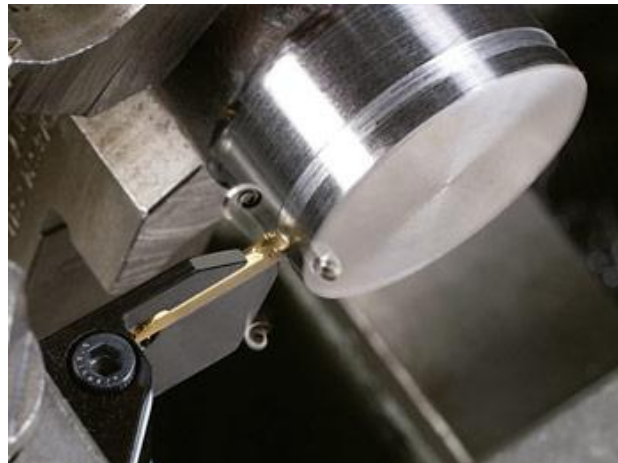
Ilustración 5.2 - Ejemplo de ranurado.
