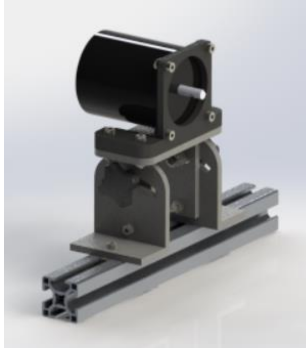
Ilustración 4.16 - Estructura para el eje de entrada fijada a parte de la bancada.
