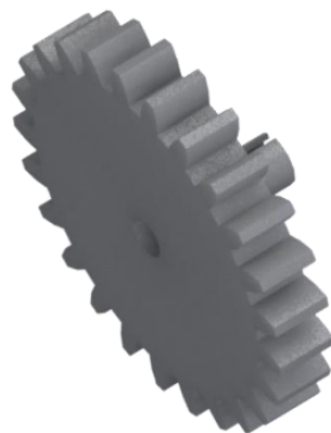
Ilustración 4.33 - Rueda dentada del tacómetro.
