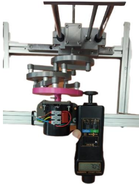
Ilustración 3.29 - Toma de velocidad del plato primario.
