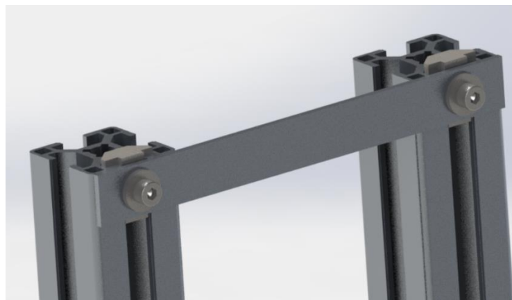
Ilustración 4.20 - Placa de sujeción de los perfiles.
