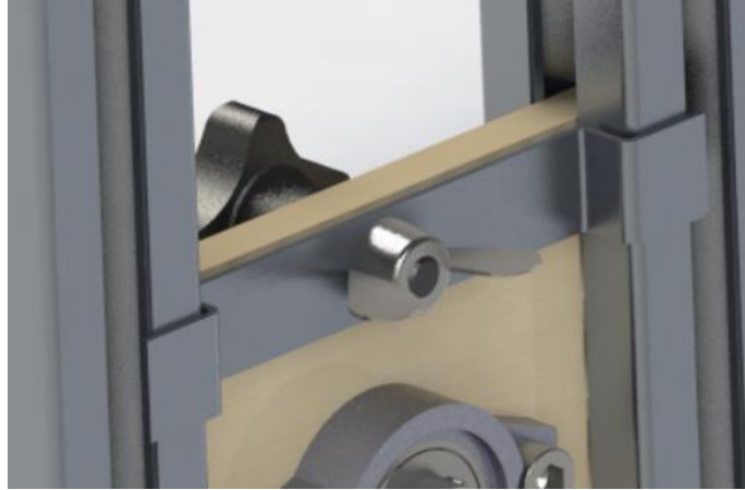
Ilustración 4.19 - Placa que actúa como pinza.
