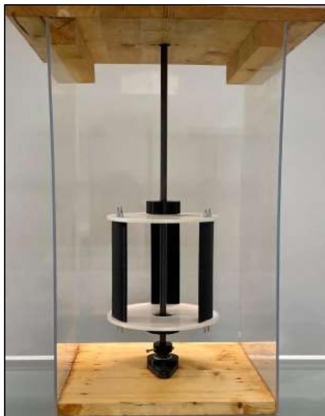
Figura 5. Características geométricas de la turbina Darrieus [Elaboración propia].
