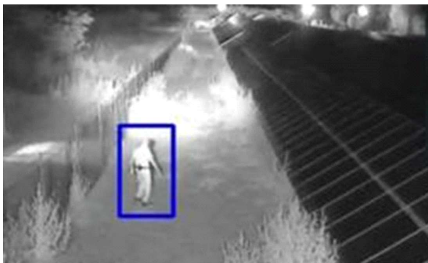
Figura 41. Ejemplo de un sistema de vigilancia con detección de intrusión[47].
