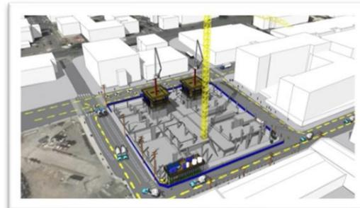
Figura 25 Secuencia logística de construcción del proyecto 700 Dexter de Turner, recuperado de [Turner Construction Case Study \(sketchup.com\)](#).
