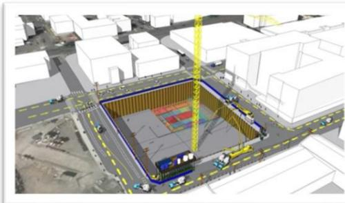
Figura 23 Secuencia logística de construcción del proyecto 700 Dexter de Turner, recuperado de [Turner Construction Case Study \(sketchup.com\)](#).
