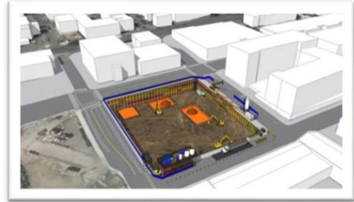
Figura 19 Secuencia logística de construcción del proyecto 700 Dexter de Turner, recuperado de [Turner Construction Case Study \(sketchup.com\)](#).
