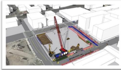
Figura 18 Secuencia logística de construcción del proyecto 700 Dexter de Turner, recuperado de [Turner Construction Case Study \(sketchup.com\)](#).
