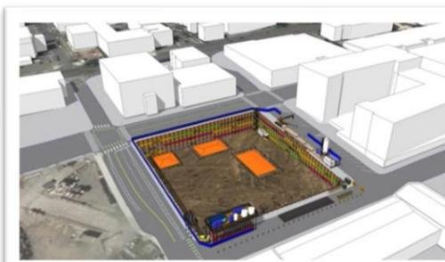
Figura 20 Secuencia logística de construcción del proyecto 700 Dexter de Turner, recuperado de [Turner Construction Case Study \(sketchup.com\)](#).
