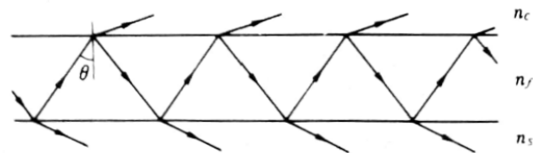
Figura 8: Modo Radiado de la guía (Sustrato y Cubierta). \theta_i < \theta_{c,c} [7]
