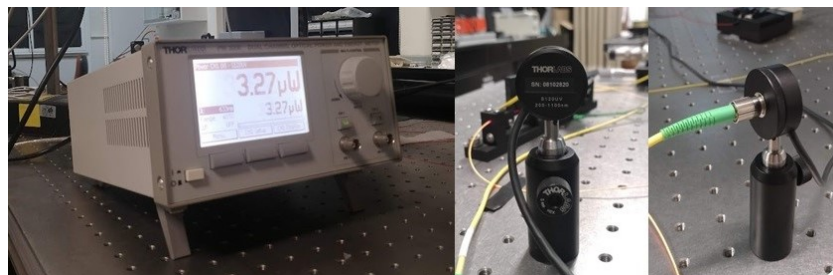
Figura 64: Sensor y medidor de potencia óptica
