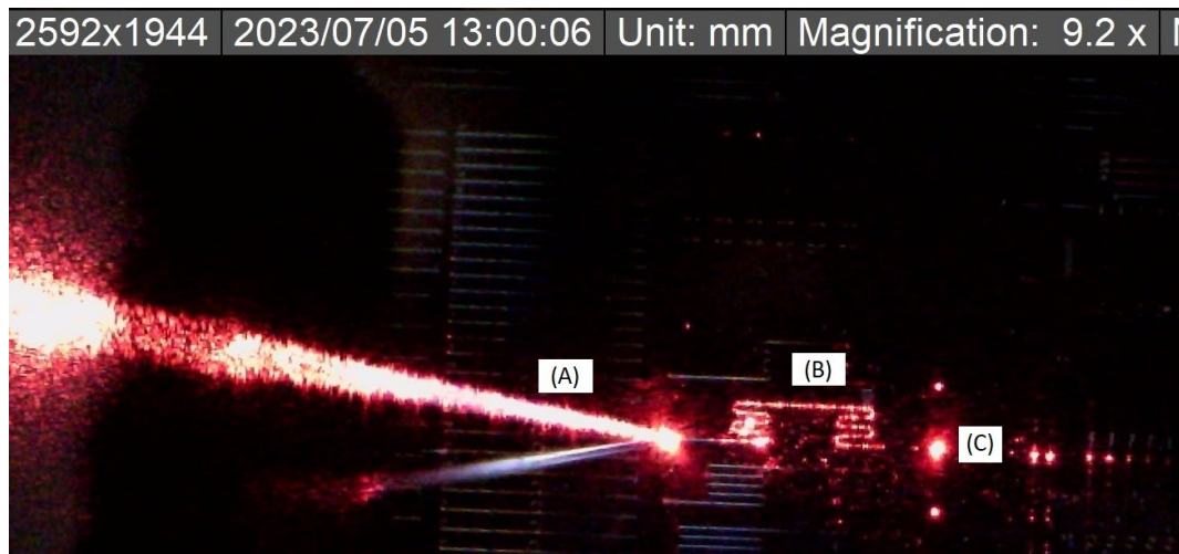
Figura 70: Imagen real del acoplamiento de la luz en una guía
