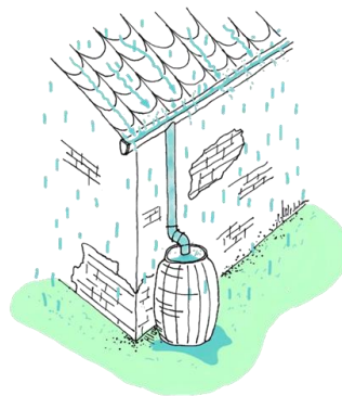
Ilustración 30: Depósito de recolección de lluvia
