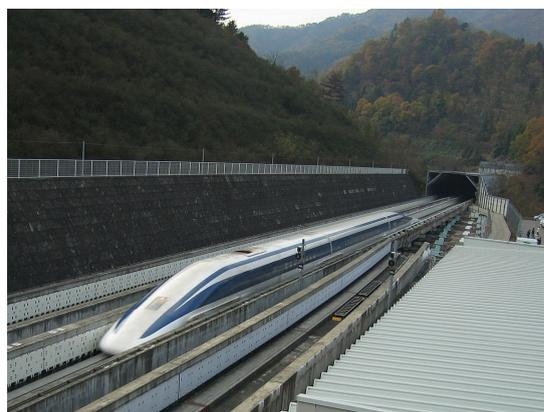
(b) Tren maglev japonés o JR maglev en movimiento en una pista de prueba. Una serie de superconductores colocados en su parte inferior repelen el campo magnético producido por los raíles debido a la polaridad [25].
