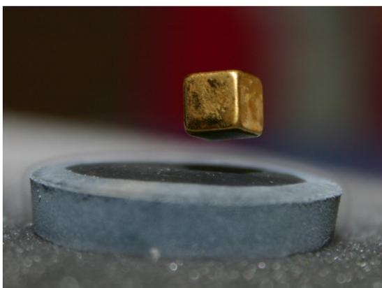
(a) Imán suspendido sobre un superconductor. Apréciase el nitrógeno líquido rodeando al superconductor, más visible en los bordes. La temperatura del superconductor es de  $-200\text{ }^{\circ}\text{C}$ , equivalentemente  $73\text{ K}$  [24].
