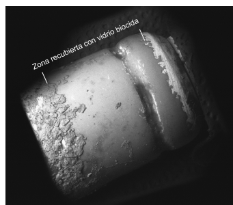
Figura 6.3.1: Acción del recubrimiento con vidrio biocida[27]
