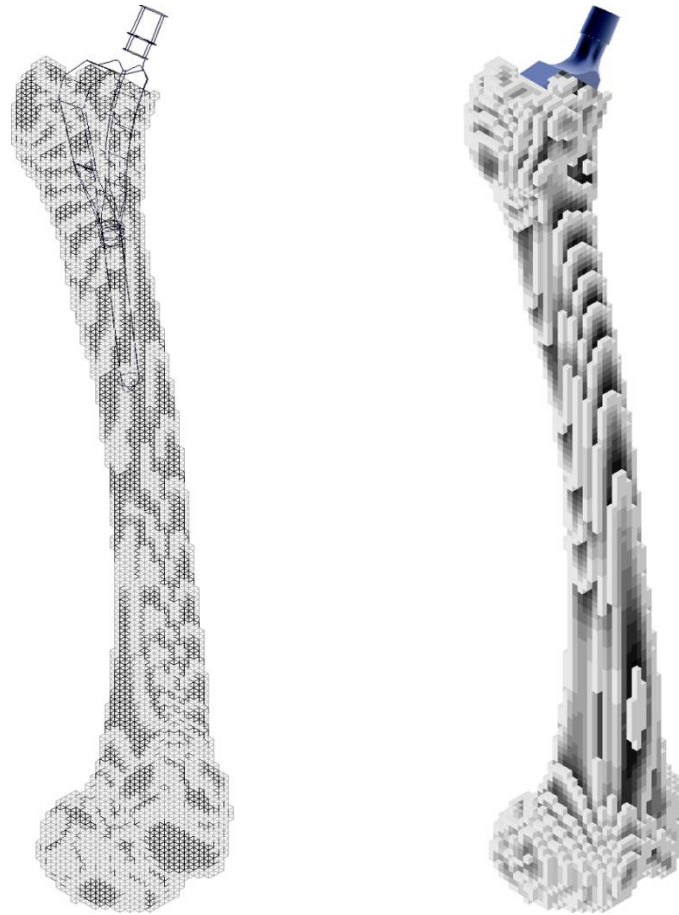
Figura 1.2 Simulación virtual de una artroplastia de cadera que produce resección ósea
