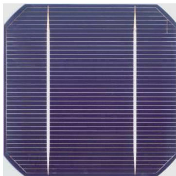
Ilustración 12. Célula de silicio monocristalino.
