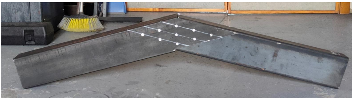
Figura 36.- Modelo utilizado en el laboratorio de la unión de cumbrera entre dinteles
