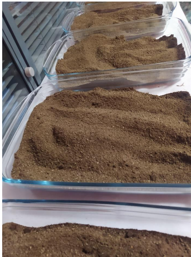
Figura 11. Microcosmos con las muestras de suelo, diésel y enmiendas orgánicas para simular técnica landfarming
