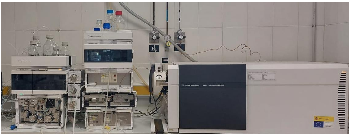
Figura 5: Equipo de cromatografía líquida de alta resolución Agilent 1290 acoplado a espectrometría de masas tándem con fuente de ionización ESI y analizador de masas de triple cuadrupolo Agilent 6460.
