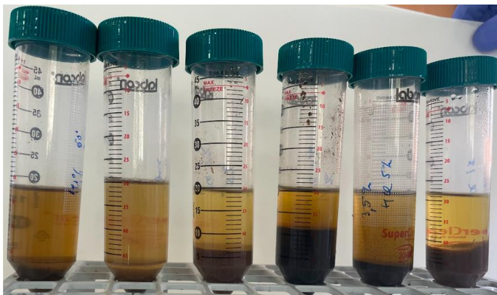
Fig. I.19. Muestras de hidrolizado de rastrojo de maíz tras centrifugado.
