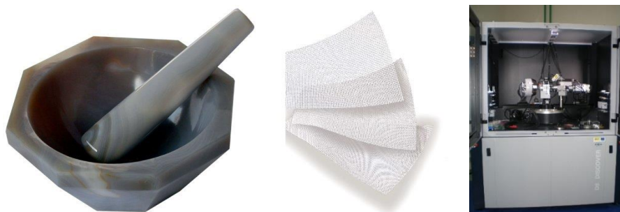
FIGURA 2: Mortero de ágata, malla de Nylon de 63\ \mu\text{m} difractor de Rayos X multipropósito, Bulker D8 Discover, de Servicios Científico-Técnicos de la Universidad de Oviedo.
