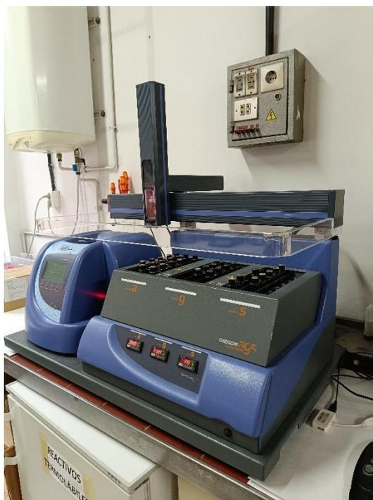
Figura 12 Equipo Turbiscan Lab (Formulation)
