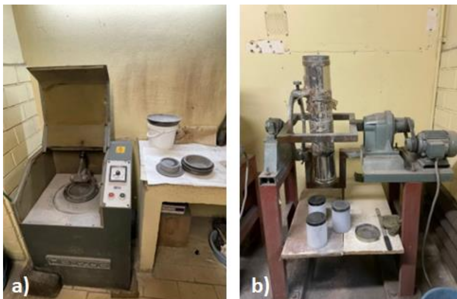
Figura 2.7: Maquinaria utilizada en el ensayo de lixiviado ex situ : molino de anillos clásico de Hezog (a) y máquina de lixiviado (b) diseñada y fabricada en la propia escuela de acuerdo con las especificaciones de la norma.
