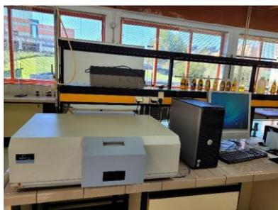
Figura 5: Imagen tomada del Espectrómetro de luminiscencia LS45 PerkinElmer.
