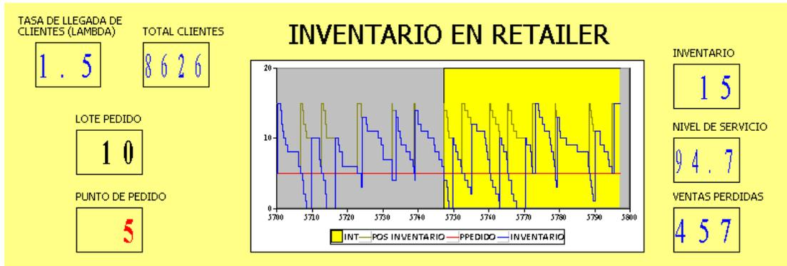
Ilustración 40. Visualización del efecto de una interrupción en las herramientas de visualización incorporadas en el modelo (Elaboración propia mediante el software Arena)
