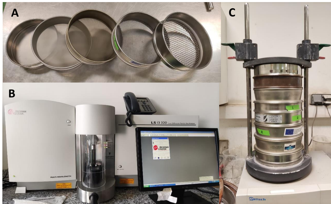
Figura 7: Tamices de granulometría (A), analizador de tamaño de partículas (B) y proceso de tamizado con tamizadora electromagnética (C).
