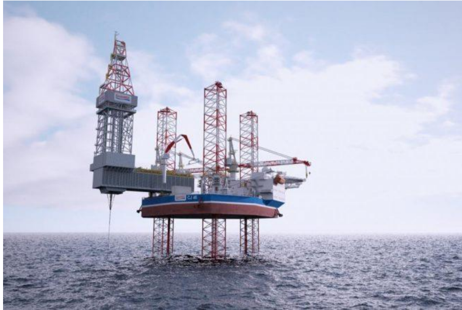
Figura 3. Ejemplo de plataforma Jack-up
