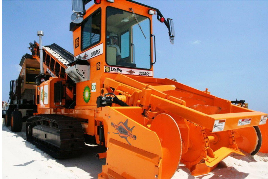
Figura 74. Máquina limpiadora de playas "Sand shark" de BP
