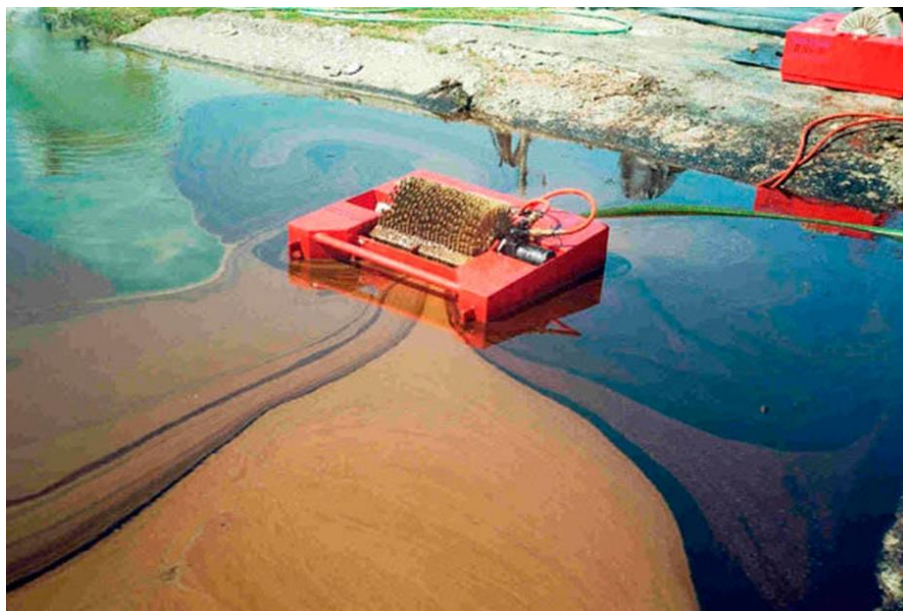
Figura 38. Ejemplo de skimmer en funcionamiento
