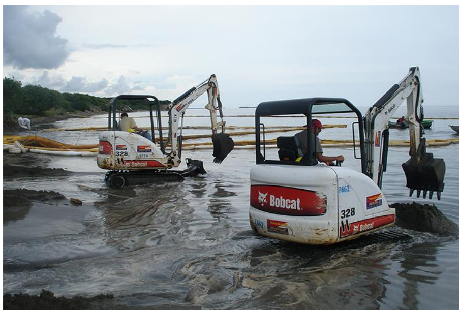
Figura 43. Ejemplo de limpieza mecánica en la costa
