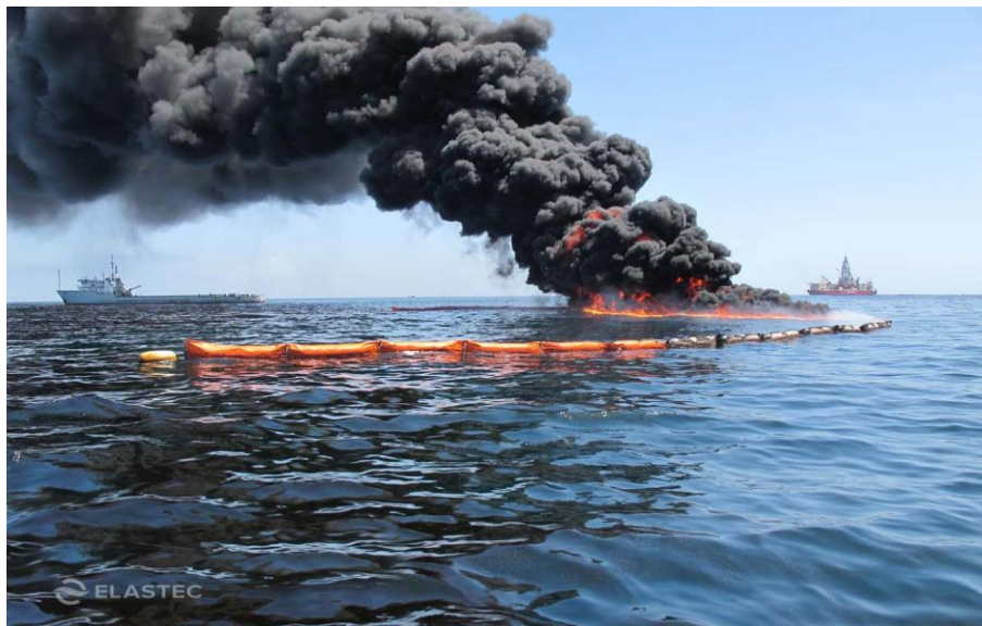
Figura 39. Ejemplo de combustión in situ
