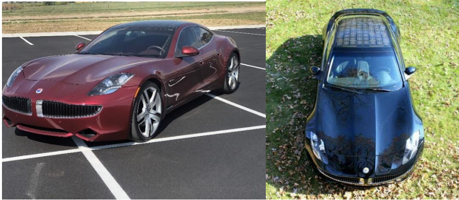
Figura 18: Fisker Karma con paneles solares
