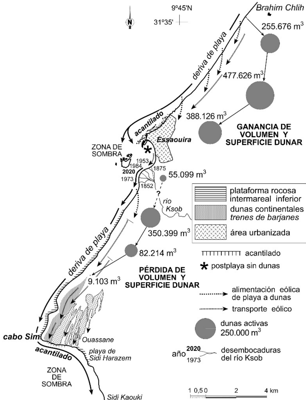
Figura 8. Síntesis del transporte y sedimentación en sentido longitudinal (playas de Essaouira de N a S) y transversal (de playas a dunas adyacentes), deducidas de los parámetros granulométricos y contenido carbonatado biogénico originales y promediados (Tablas 2 y 3). Los volúmenes representan las acumulaciones arenosas de las dunas activas (Flor-Blanco et al., 2013), que permiten completar el esquema de los flujos arenosos en esta costa baja atlántica de Marruecos.
