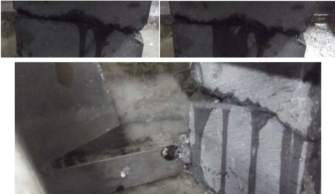
Figura 19. Flujo de agua a través de la junta a baja presión (izquierda) y a presiones elevadas (derecha y abajo) (Guerrero Miguel et al., 2018)
