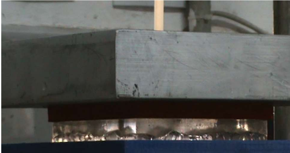
Figura 71. Surgimiento homogéneo a lo largo de la junta para tensiones y presiones de inyección bajas
