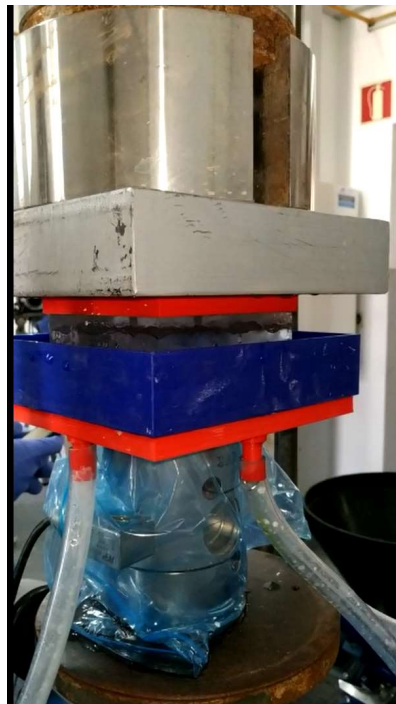
Figura 39. Detalle de la disposición de la célula y el cilindro de carga, con la junta y la bandeja
