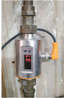
Figura 42 Caudalímetro empleado durante un ensayo que registra 3,7 l/min
