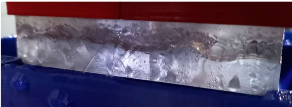
Figura 72. Surgimiento en forma de chorro, característico de tensiones y presiones elevadas
