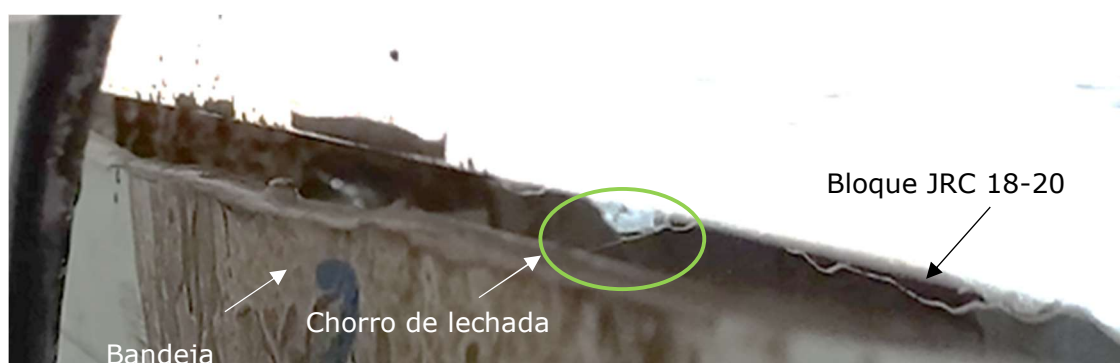
Figura 73. Chorro de lechada en la dirección 1 para JRC 18-20 y tensión normal de 2,0 MPa
