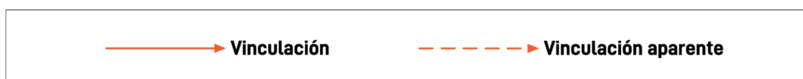
Figura 6. Código gráfico para vinculación certera y para posible vinculación entre factores en el Árbol de fallos
