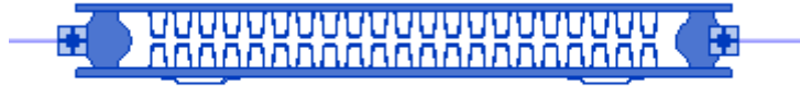
Figura 3.47 Radiador escogido, como se puede ver tiene dos conexiones disponibles a ambos lados, a diferencia de los radiadores arquitectónicos que no tienen ninguna.
