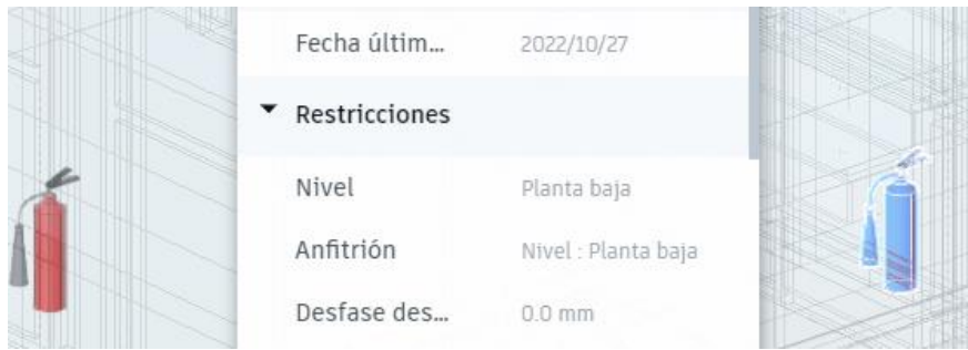
Figura 4.5 Extintores con sus propiedades y parámetros
