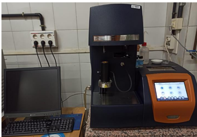
Figura 8. Dispositivo experimental para el análisis termogravimétrico
