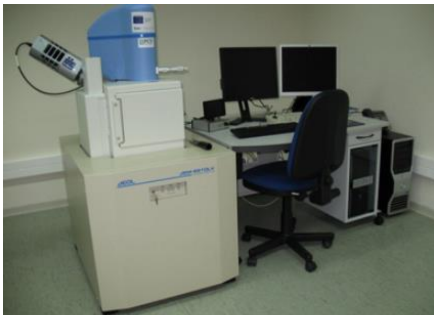
Figura 6. Equipo JEOL 6610LV disponible en los Servicios Científico Técnico de la Universidad de Oviedo
