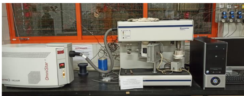
Figura 9. Equipo experimental para la desorción a temperatura programada
