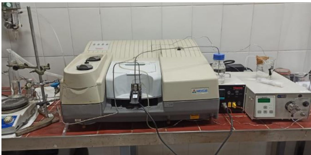
Figura 10. Dispositivo experimental para espectroscopia infrarroja en modo de reflectancia difusa
