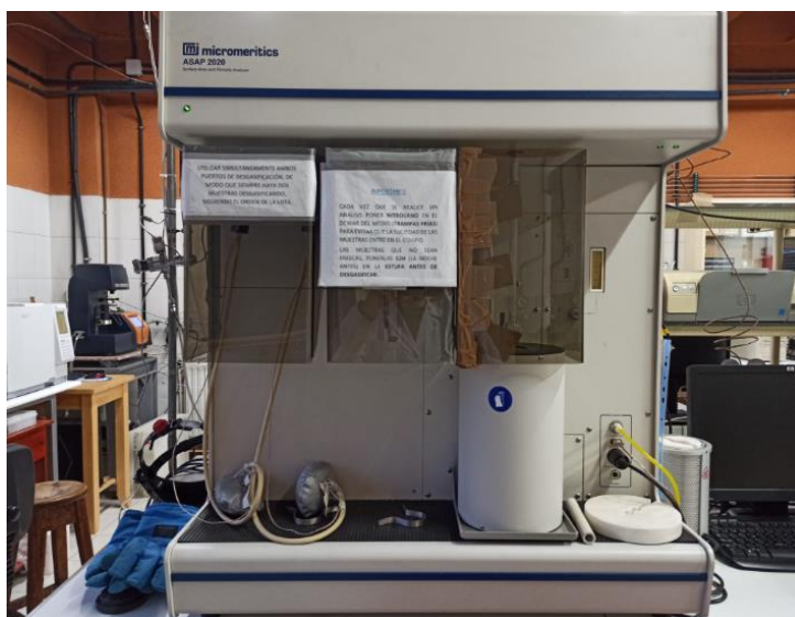
Figura 7. Equipo empleado para la adsorción-desorción con nitrógeno
