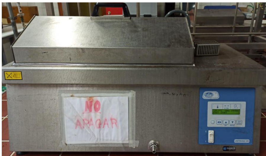
Figura 11. Baño termostático empleado para la adsorción
