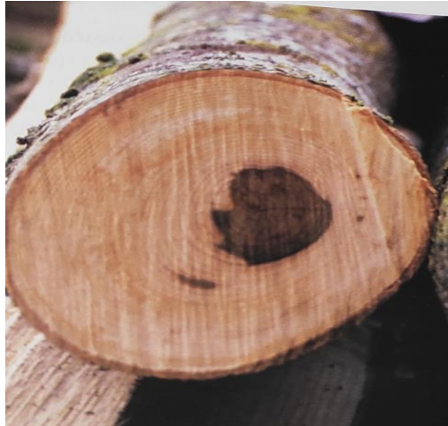
Figura 10. Corazón negro en madera de Fraxinus excelsior . Fuente: Manual de Selvicultura para plantaciones de especies productoras de madera de calidad. Ministerio de Ciencia y Tecnología. Instituto Nacional de Investigación y Tecnología Agraria y Alimentaria.
