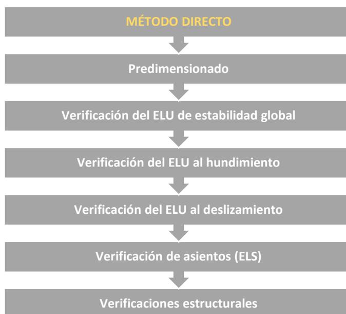
**Figura 4.3. Secuencia de comprobaciones para el dimensionamiento de cimentaciones superficiales por el método directo.**
