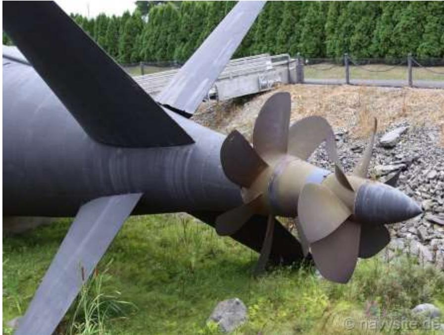
Figura 11 Hélice contra-rotativa del USS Albacore
