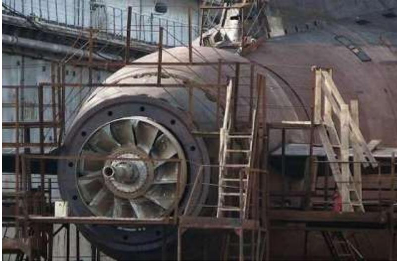
**Figura 15 Pump-Jet del submarino Ruso Alrosa al descubierto.**
