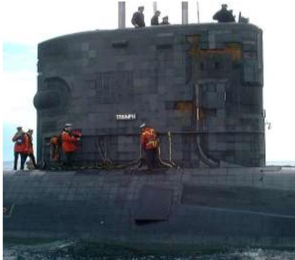
Figura 20 Placas anecoicas del HMS Triumph
