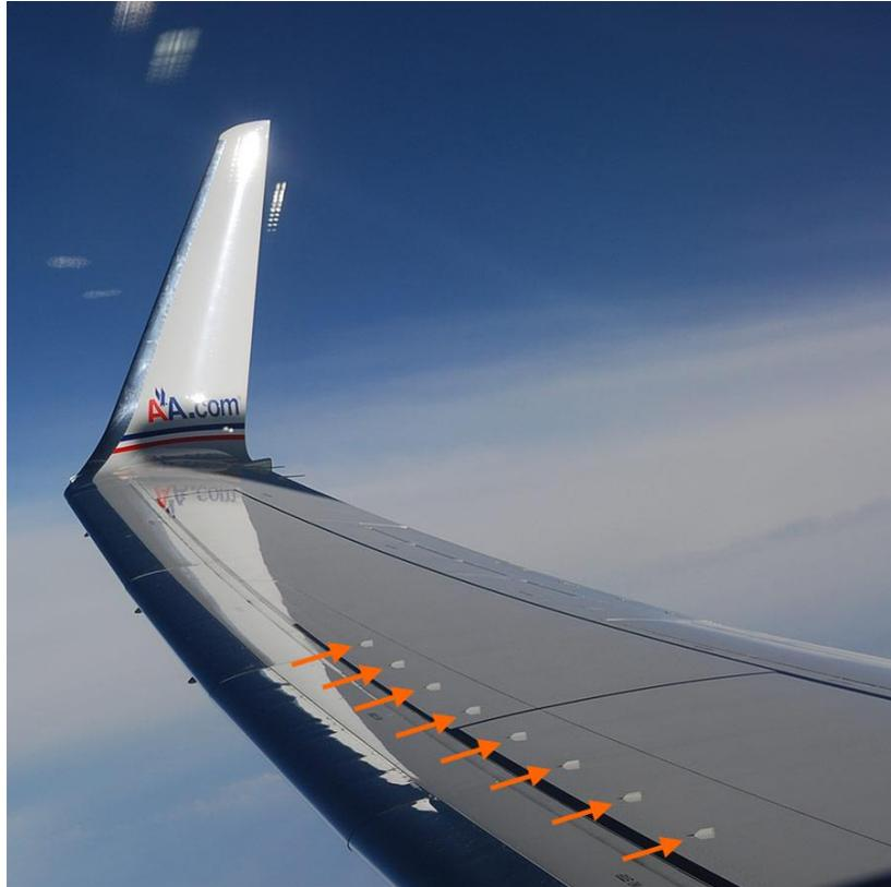
Figura 2.10. Generadores de vórtices en un avión comercial [8].
