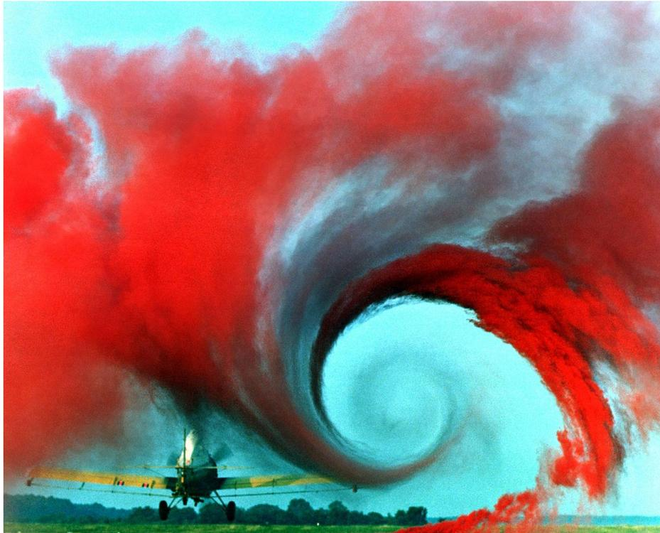
Figura 2.9. Vórtice en el extremo del ala de un avión [7].
